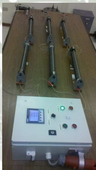
Circuito trifásico conectado al analizador de redes
