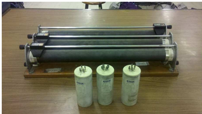
Carga trifásica balanceada
