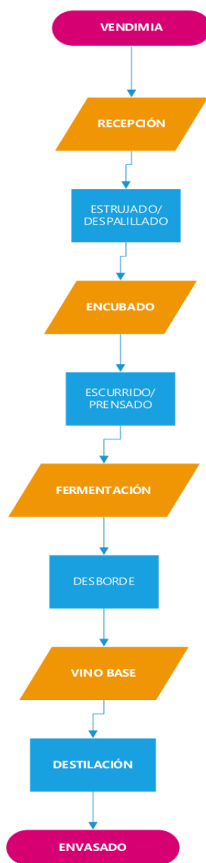
Figura 4. Diagrama de Flujo de la elaboración del Pisco
