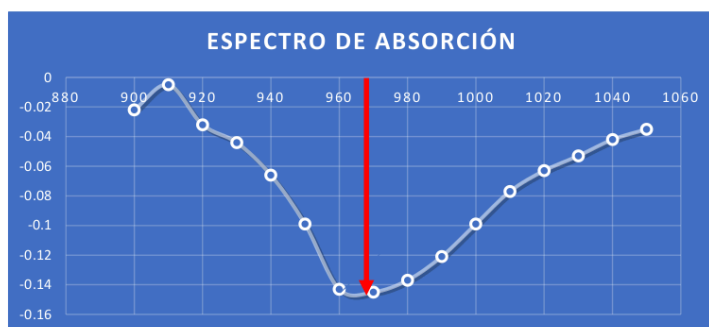
Gráfica 1. Espectro de absorción de la solución patrón de etanol absoluto
