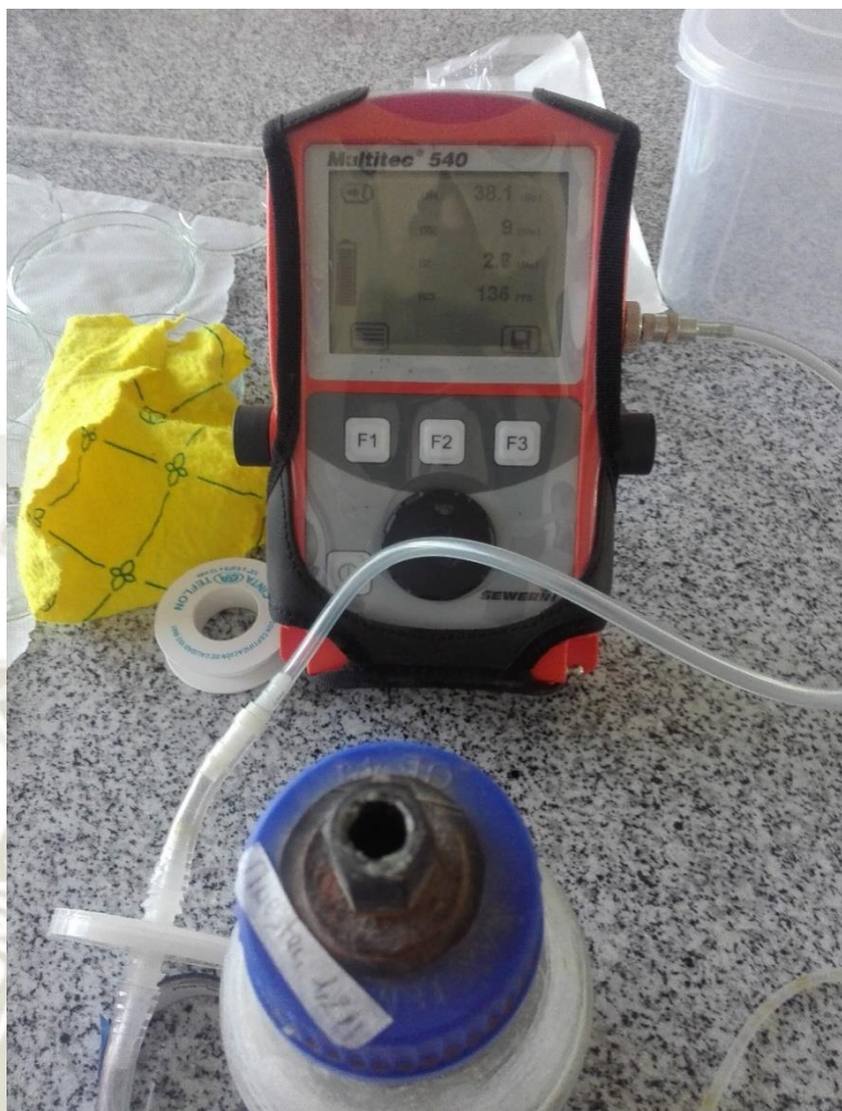
Figura 3: Medidor de biogas
