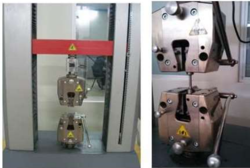
Figura 1 : (a-b): Máquina de Tracción 50 kN - Precisión 1kN
