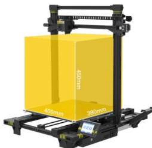
Figura 66: Impresora Anycubic Chiron
