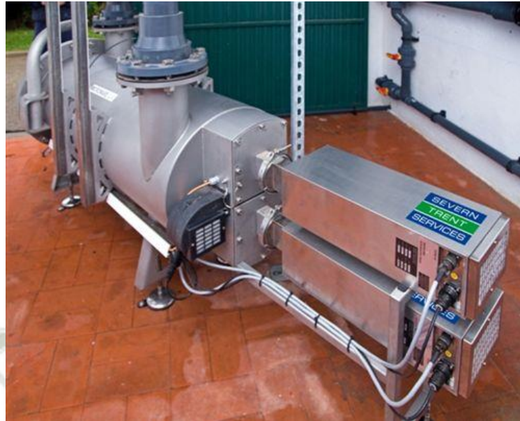
Figura N°12 – Desinfección por Microondas para el tratamiento de Residuos Sólidos Hospitalarios
