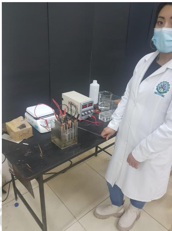
Fotografía 7: Preparación del Sistema de Electrocoagulación.
