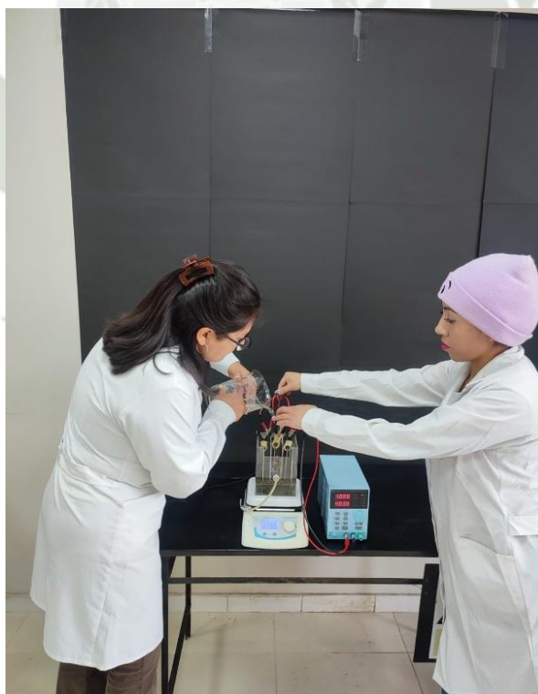
Fotografía 10: Armado del Sistema de Electrocoagulación en Laboratorio.
