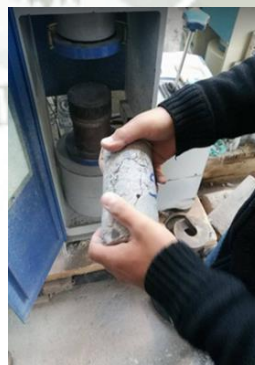
Figura 116 Testigo de la diamantina sometida a carga axial.
