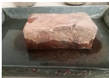
Figura 110 Ladrillo recocado colocado sobre la capa de agua, se observa su alta capacidad de succión.
