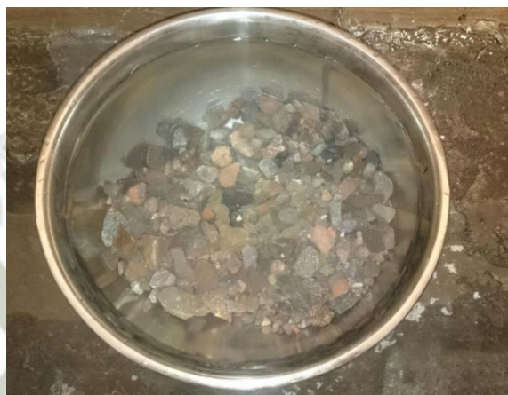
Figura 98 Lavado del agregado grueso.
