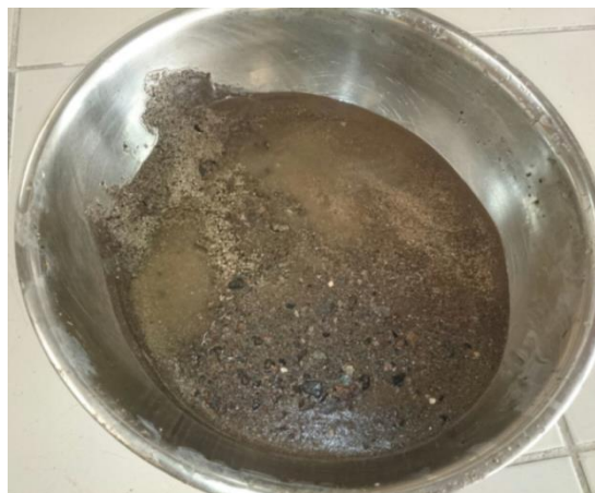
Figura 89 Saturación del Agregado Fino
