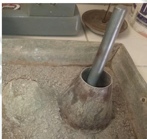
Figura 87 Molde cónico para el Ensayo de Peso Específico y Absorción.
