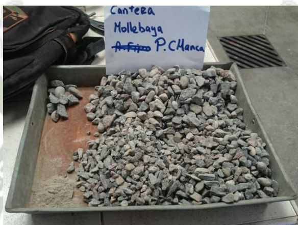
Figura 92 Agregado Grueso (Piedra Chancada) de la cantera de Mollebaya luego de ser tamizada.
