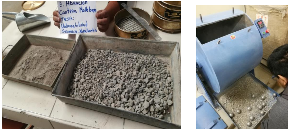
Figura 104 Comparación del Agregado después de ser ensayado con una muestra de agregado natural (Arriba); Agregado retirado después de haber sido ensayado, se pueden contar las once billas de trituración (Derecha)
