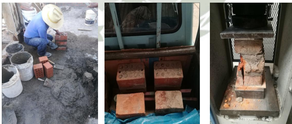
Figura 112 Fabricación de las pilas al pie de obra con materiales encontrados en ella (Izquierda); Transporte de pilas con el debido amortiguamiento (Centro); Pila de ladrillos refrentada, luego de ser ensayada, se identifica una falla longitudinal (Derecha)
