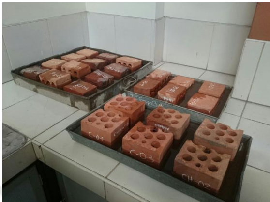
Figura 109 Unidades de Albañilería sumergidas en agua.
