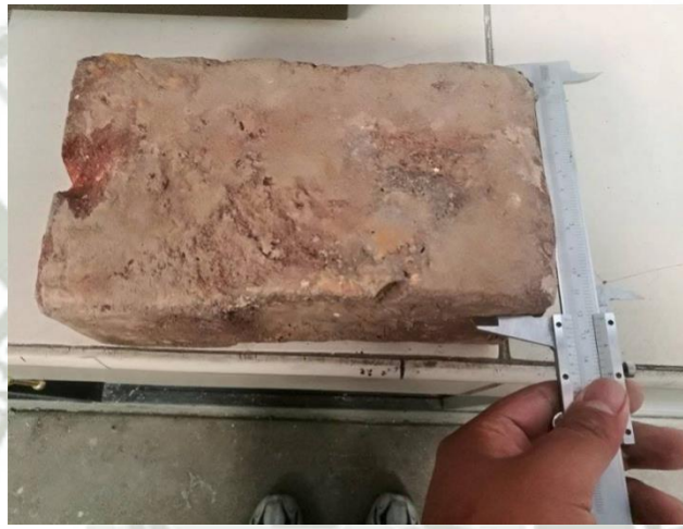
Figura 107 Medición del ancho de un ladrillo recocido.
