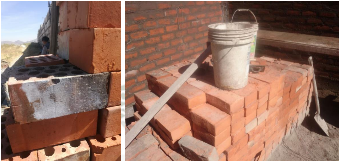
Figura 37 Ladrillo quemado por extensión del tiempo en el tiempo de cocción SC-02 (Izquierda); Ladrillos mal cocidos de color amarillento blanquecino el cual demostró tener resistencias significativamente menores a los bien cocidos SA-03 (Derecha)
