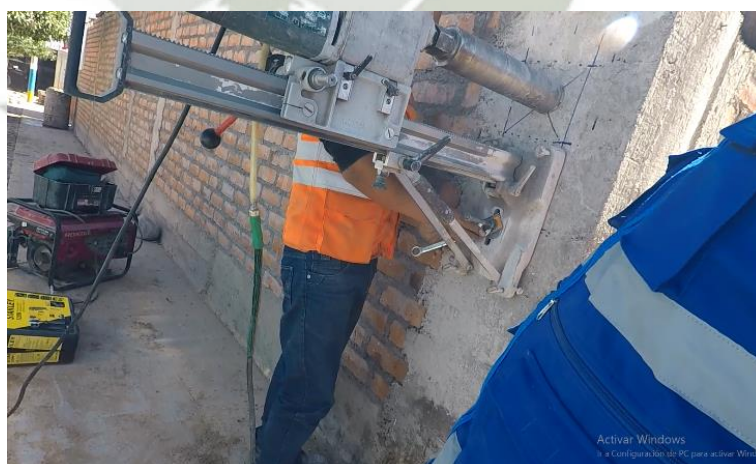
Figura 114 Se Observa precisos instantes donde se extrae el testigo por método de la Diamantina.
