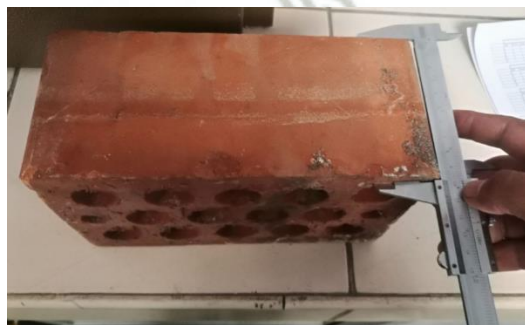
Figura 106 Medición de dimensiones en unidad de albañilería
