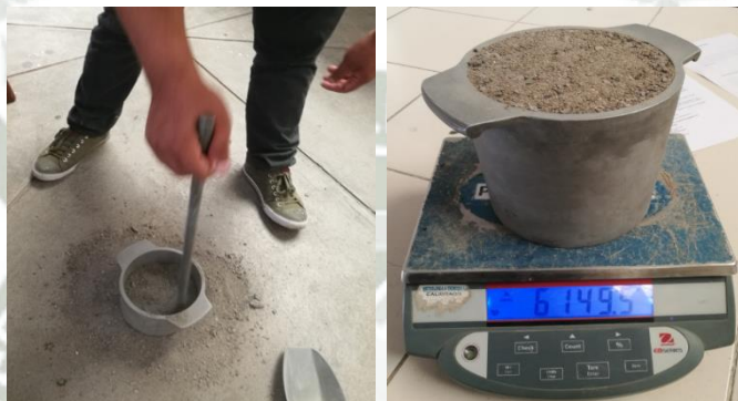
Figura 88 Compactación con varilla lisa de 5/8" y pesaje del agregado fino suelto cantera Mollebaya.
