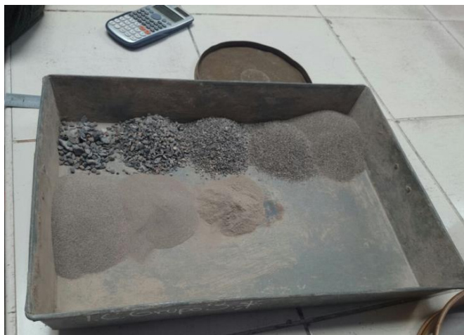
Figura 84 Agregado fino de la cantera de Mollebaya luego de haber sido tamizada.
