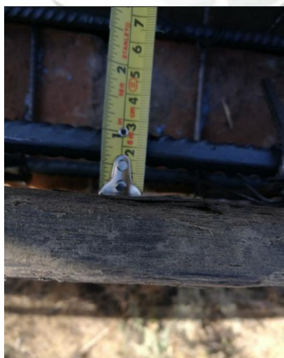
Figura 73 Medición del recubrimiento, 1.80 cm SA-02
