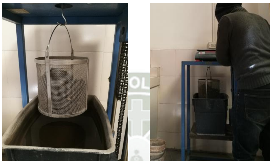
Figura 95 Agregado Grueso siendo sumergido en la cubeta de agua, para su posterior pesaje
