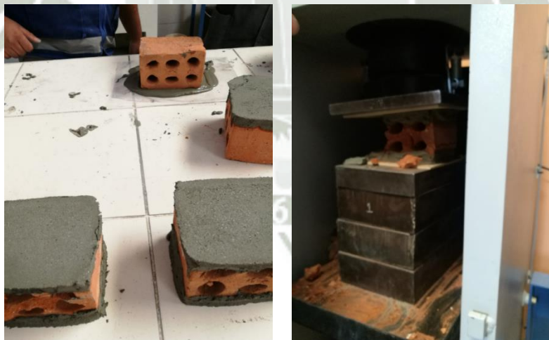
Figura 105 Colocación del refrentado de yeso y cemento en la parte superior e inferior de las unidades de albañilería (Izquierda); Unidad de albañilería ensayada (Derecha)
