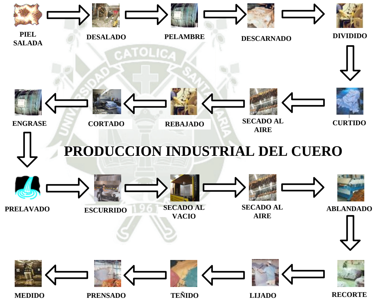
Figura Nro. 6 Flowsheet Producción Industrial del cuero
