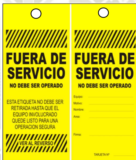
Figura Nro. 36 Etiquetado Equipo Fuera de Servicio
