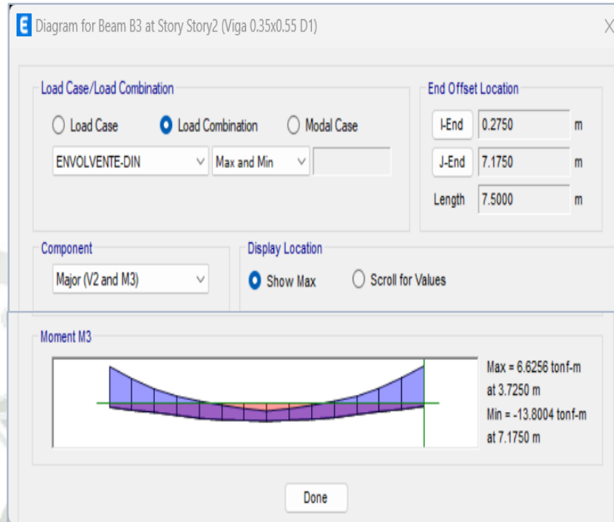
Gráfico 64: Envolverte de Momento Flector de la Viga
