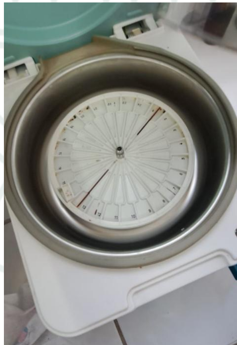
Figura 84. Muestra de sangre en un capilar de micro hematocrito en la centrifuga.
