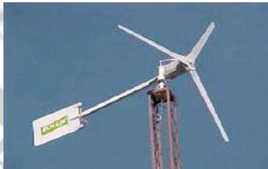
Figura 15. Generador eólico de eje horizontal
