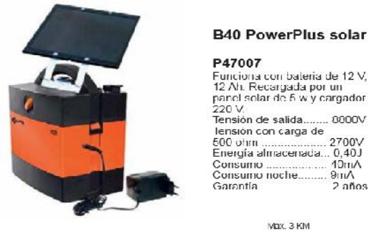
Figura 43. Pulsador para cerca eléctrica fotovoltaica
