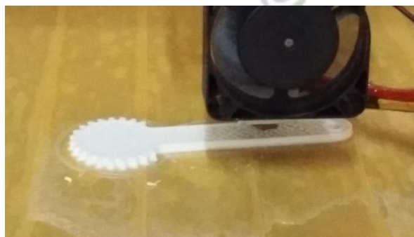
Figura 4.17: Impresión 3D de Engranaje Fuente: Propia
