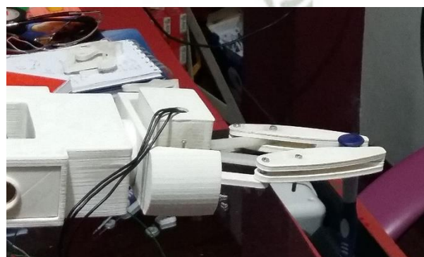
Figura 4.64: Prueba de funcionamiento del Efector Final. Fuente: Propia
