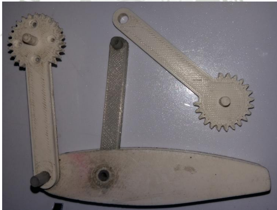
Figura 4.67: Instalación de bujes en los puntos de unión del Efector Final.
