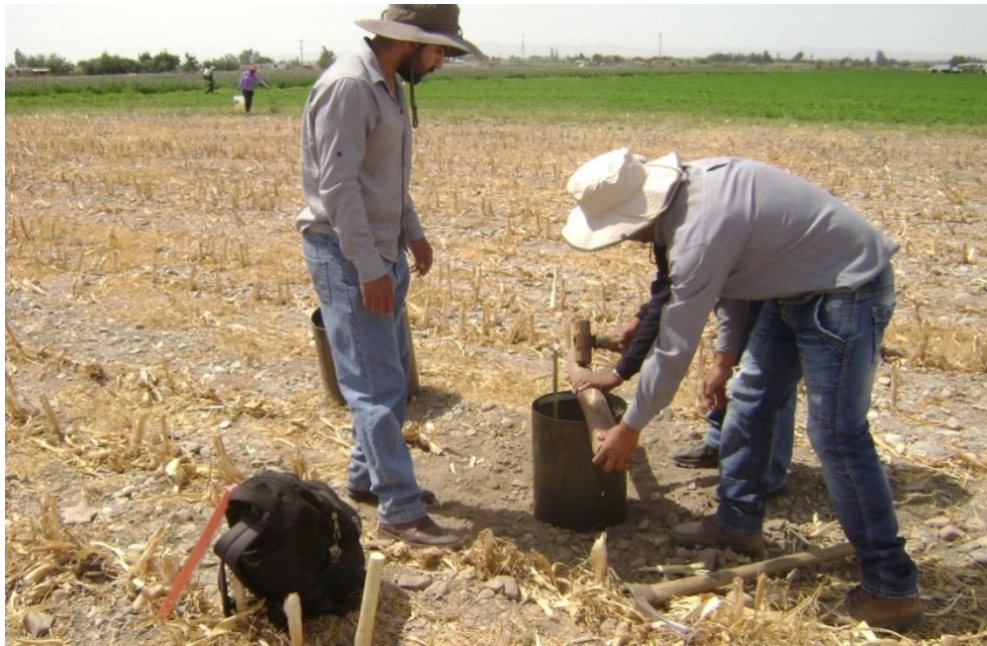
Fotografía 3: Prueba de Infiltración – clavado de cilindros
