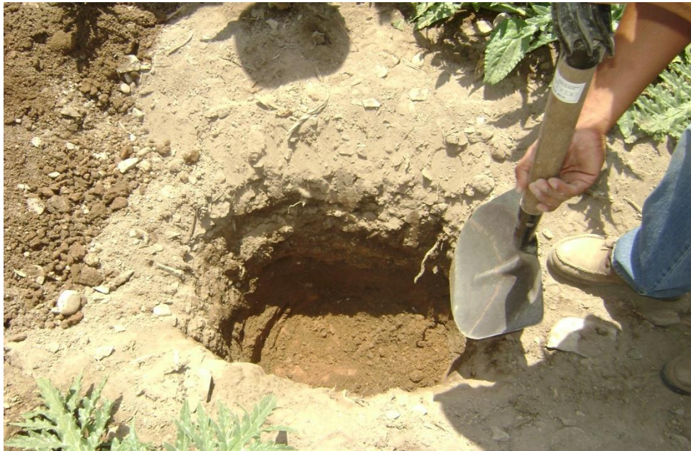
Fotografía 5: Excavación para retiro de muestra
