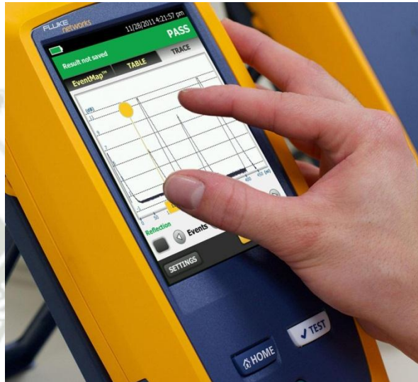
Fig. 2-18 Pantalla de trabajo, OTDR Marca Fluke.
