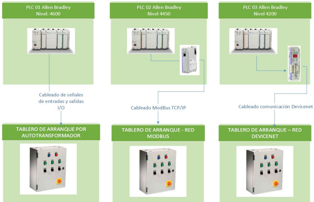
Fig. 3-75 Diagrama de PLC. Referencia: Elaboración propia.
