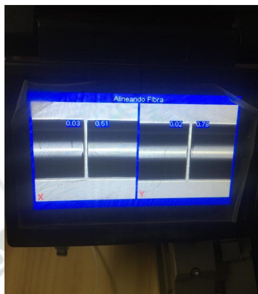
Fig. 2-25 Visualización de fibras cortadas alineadas.
