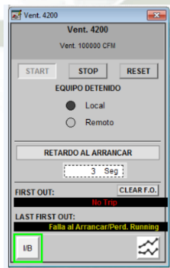
Fig. 3-68 Faceplate de Ventiladores.
