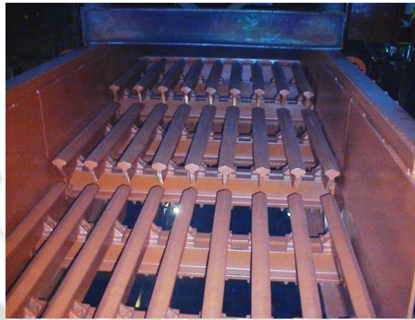
Figura 2.11 Alimentadores vibratorios grizzli
