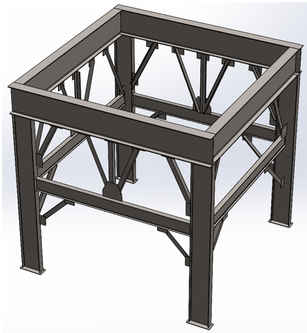
Figura 4.153 Estructura soporte de la tolva – Solidworks
