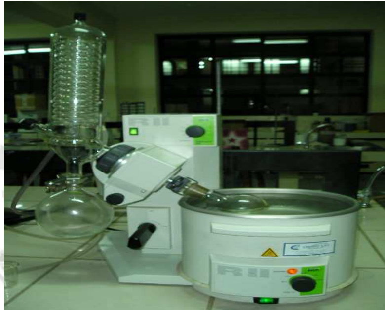
Foto N° 3: Concentrando el extracto en el rotavapor
