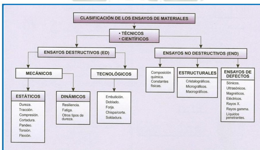
Figura N°. 1 Clasificación de ensayos de materiales
