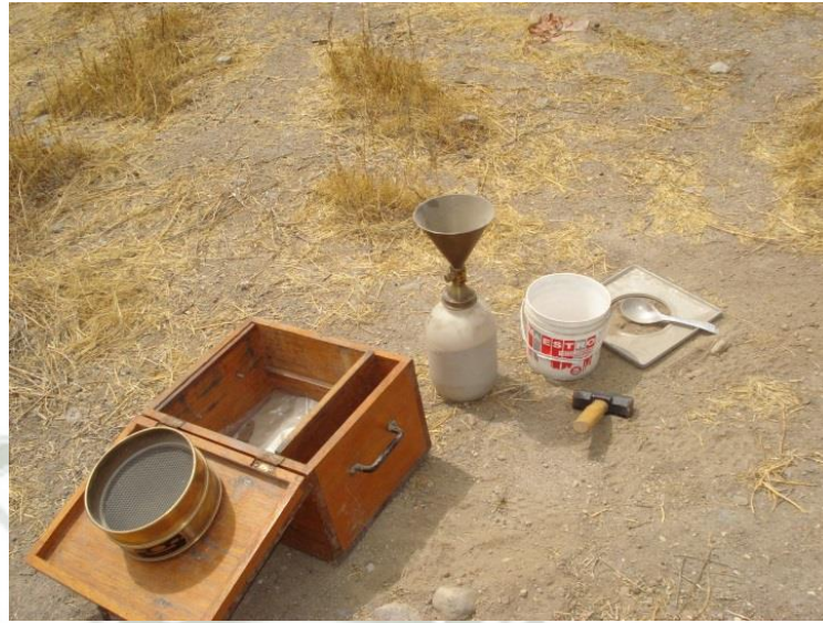
Figura 3.23: Instrumentos utilizados para la determinación in situ de la densidad (Fuente: Fotografía)
