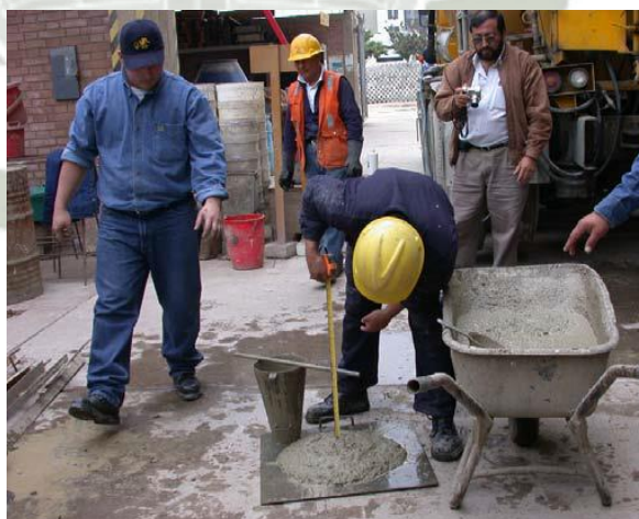
Figura 6.79: Control del slump en el concreto premezclado. (Fuente: Construcción de edificios estructurados por MDL-PUCP)
