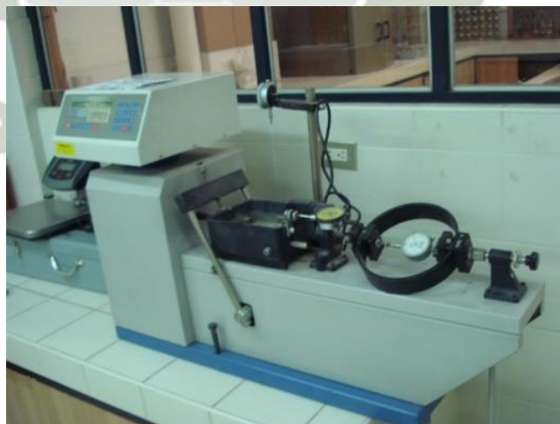
Figura 3.24:Maquina utilizada para el ensayo de corte (Fuente: Fotografía)
