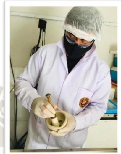
FOTO N° 5 Trituración de la muestra en mortero
