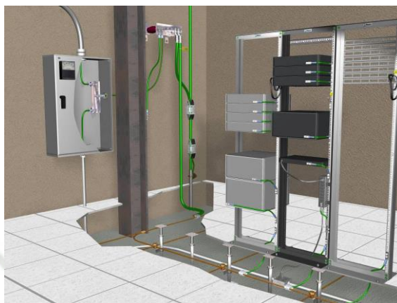
Figura 3.9: Instalación de puesta a tierra de un Data Center Fuente: "UPI-2007"
