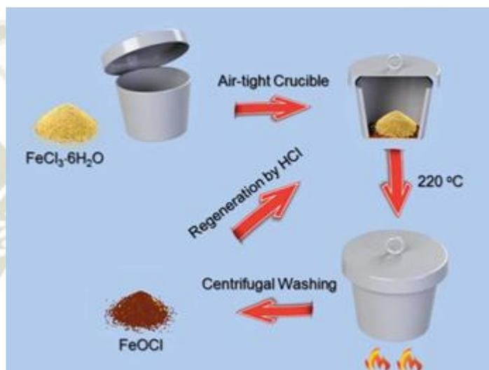
**Figura 12.** Esquema de síntesis de catalizador (42)
