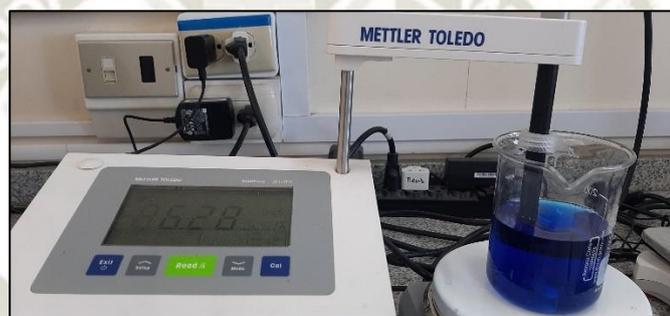
**Figura 16.** Titulación potenciométrica de VBC.
