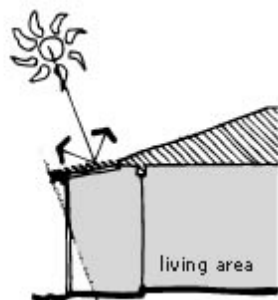
IMAGEN 9. Los aleros y los balcones cubiertos proporcionan sombreado
