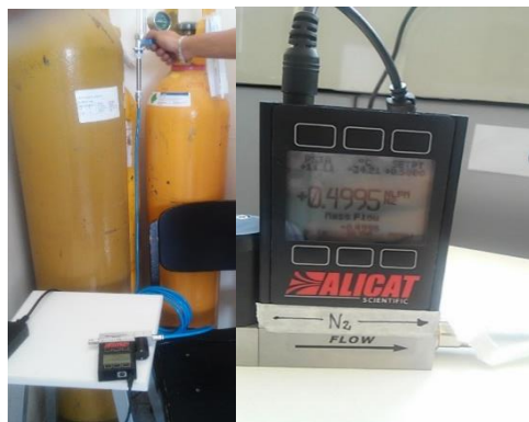
Ilustración 34. Prueba fotográfica de regulación de gas en controlador ALICAT. Fuente: Elaboración Propia
