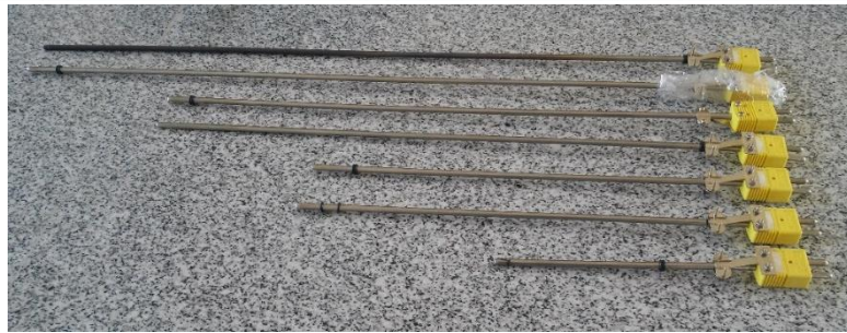
Ilustración 29. Termocuplas adquiridas, de diversas longitudes. Fuente: Elaboración Propia.
