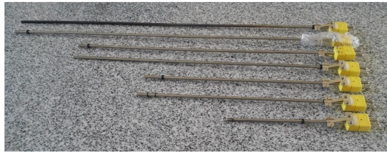
Ilustración 18. Termocuplas de longitudes de 60cm, 45cm, 30cm y 20cm. Fuente: Elaboración Propia.
