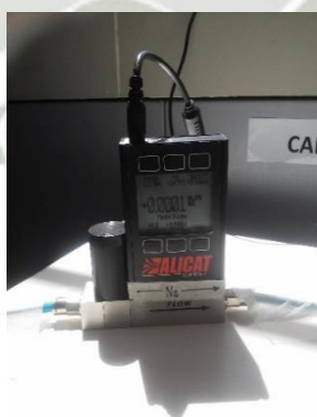
Ilustración 43. Controlador ALICAT conectado al reactor y a alimentación eléctrica. Fuente: Elaboración Propia.
