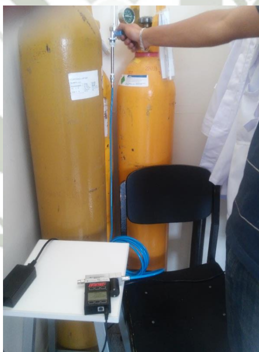
Ilustración 45. Gas nitrógeno conectado al controlado de flujo másico ALICAT. Fuente: Elaboración Propia.
