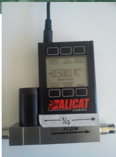
Ilustración 46. Controlador ALICAT para gas nitrógeno programado en 0.5 NLPM. Fuente: Elaboración Propia.
