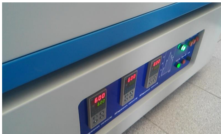
Ilustración 44. Horno reactor tubular de tres zonas , llegando a la primera rampa de 600°C. Fuente: Elaboración Propia.
