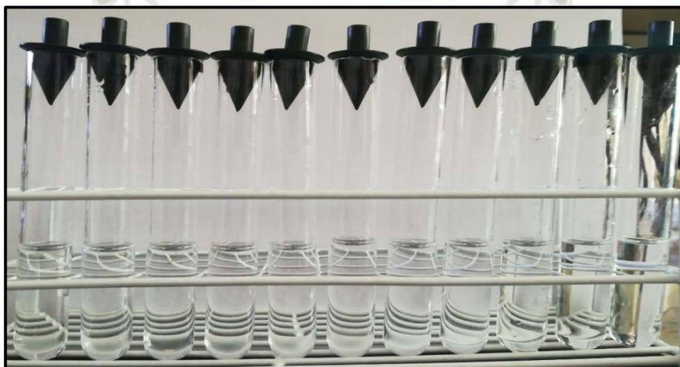
*Figura N° 17. Tubos después del proceso de digestión UV, variando el tiempo.*
