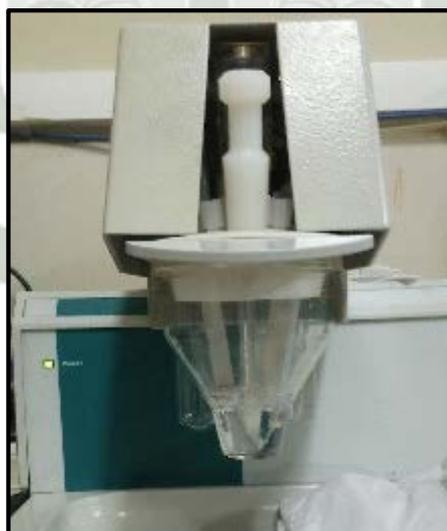
*Figura N° 19. Celda de análisis voltamperométrica.*
