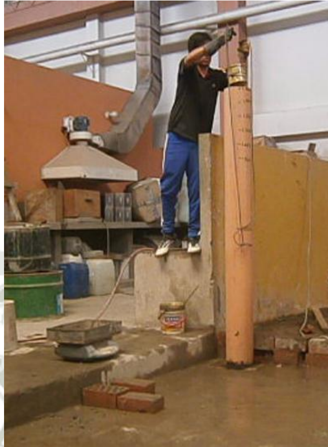
Figura 4.4 Proceso de sumergido de contenedor cilíndrico.
