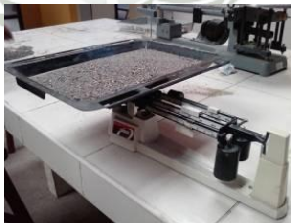
Figura 3.5. Proceso de pesado retenido por cada tamiz
