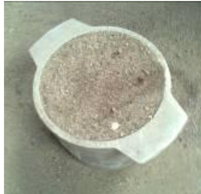
Figura 3.8. Molde a ser pesado, para hallar el peso unitario suelto
