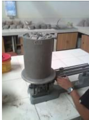
Figura 3.24. Molde con agregado grueso suelto
