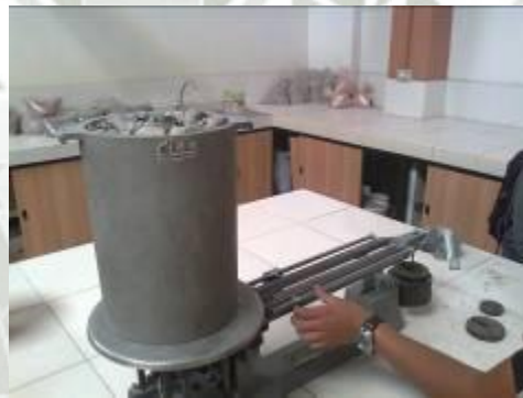
Figura 3.26. Pesado del agregado grueso compactado
