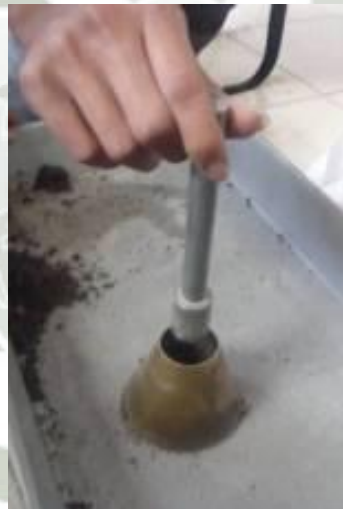
Figura 3.14. Compactación del cono de prueba
