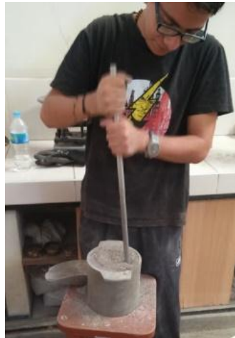
Figura 3.9. Procedimiento de compactación del agregado fino
