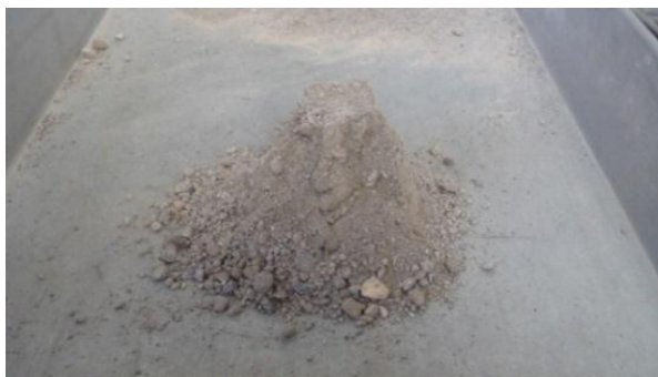
Figura 3.16. Agregado fino superficialmente seco
