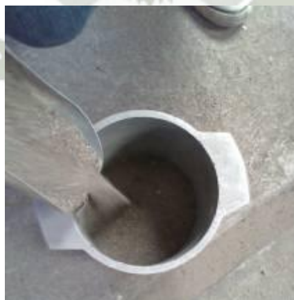
Figura 3.7. Proceso de llenado del molde de 1/10 \text{ pie}^3
