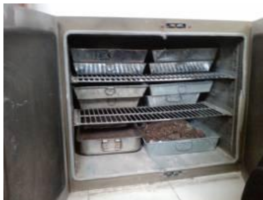
Figura 3.17. Secado del agregado fino en el horno
