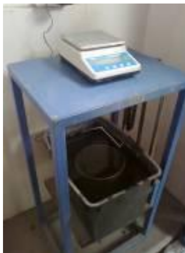
Figura 3.30. Introducción de la canasta con agregado grueso sumergido y obtención de su masa
