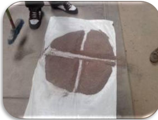
Figura 3.1. Cuarteo de la muestra de agregado fino
