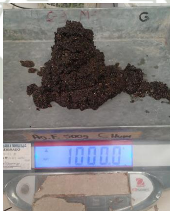
Figura 3.12. Muestra representativa de agregado totalmente saturado
