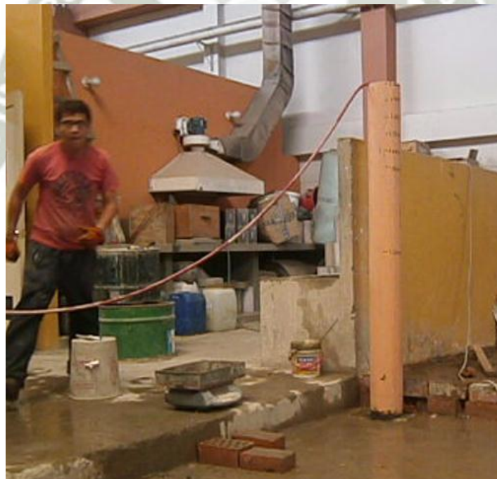
Figura 4.1 Tubo cilíndrico de 200 mm de diámetro, lleno de agua.
