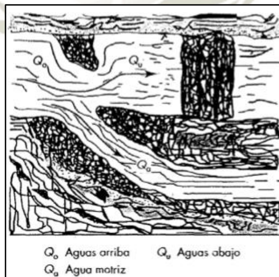
Figura 2.5. Toma lateral con espigones
