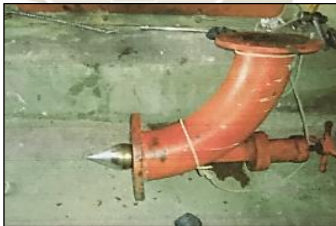
Figura 3.9. Aguja de inyector
