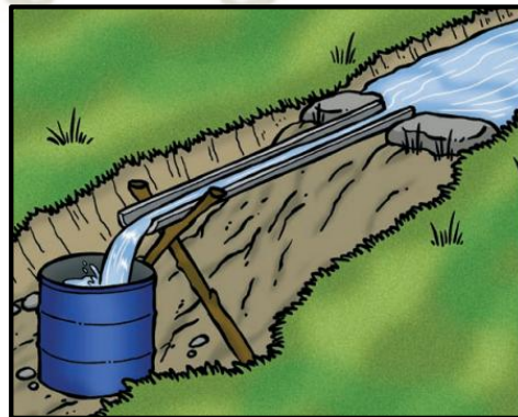
Figura 2.41. Medición del caudal por método del recipiente
