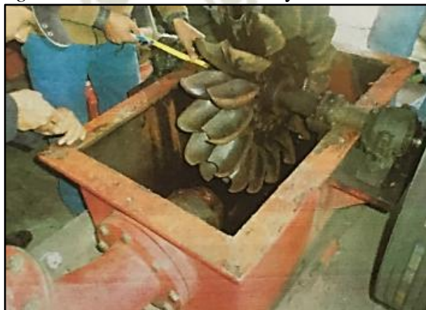
Figura 3.5. Rueda de la turbina y sus cucharas
