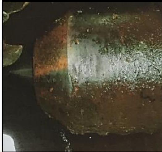
Figura 3.8. Tobera Inferior con falta de mantenimiento
