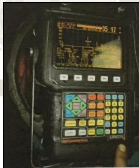
Figura 3.2. Equipo de medición por ultrasonido EPOCH 4
