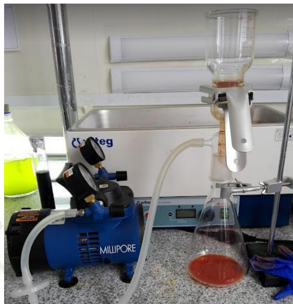
Figura 8: Sistema de filtración al vacío utilizado en la síntesis del catalizador.
