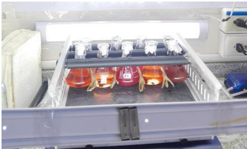
Figura 9: Sistema de tratamiento de los colorantes mediante oxidación avanzada foto-Fenton.
