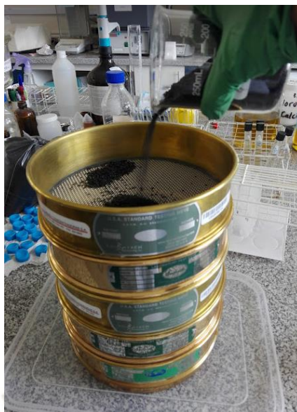
Figura 10: Proceso de tamizado de los carbones activados, a través de tamices con diferentes tamaños de mallas para obtener la granulometría apropiada por lote y a flujo continuo.
