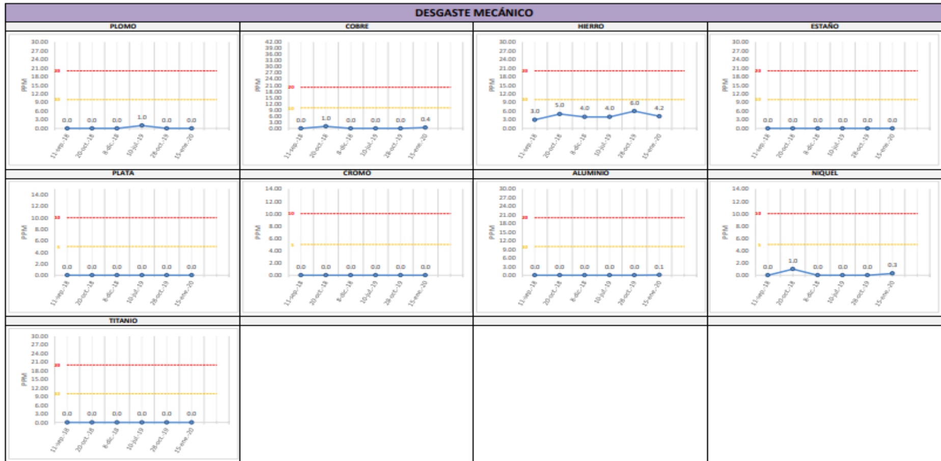
Figura 29. Tendencia de cantidad partículas por desgaste metálico lubricante utilizado en reductor de velocidad TG1.
