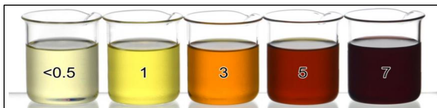
Figura 4. Ejemplo de colores aceite lubricante según norma ASTM D 1500.
