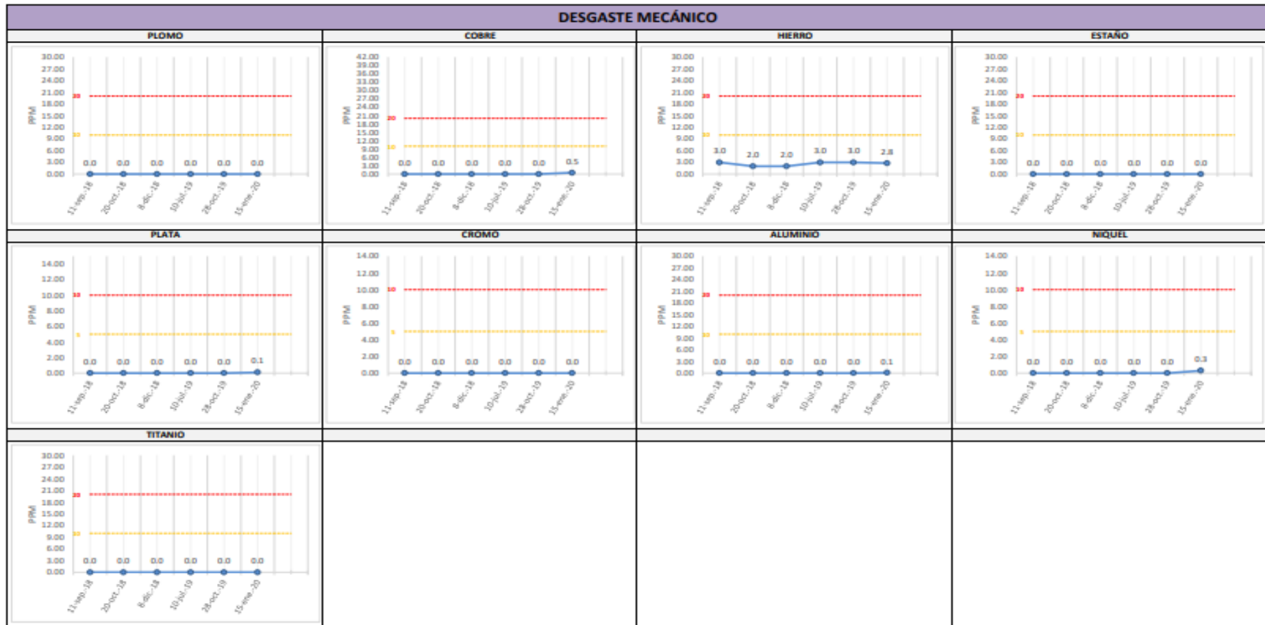
Figura 32. Tendencia de cantidad partículas por desgaste metálico lubricante utilizado en reductor de velocidad TG2.
