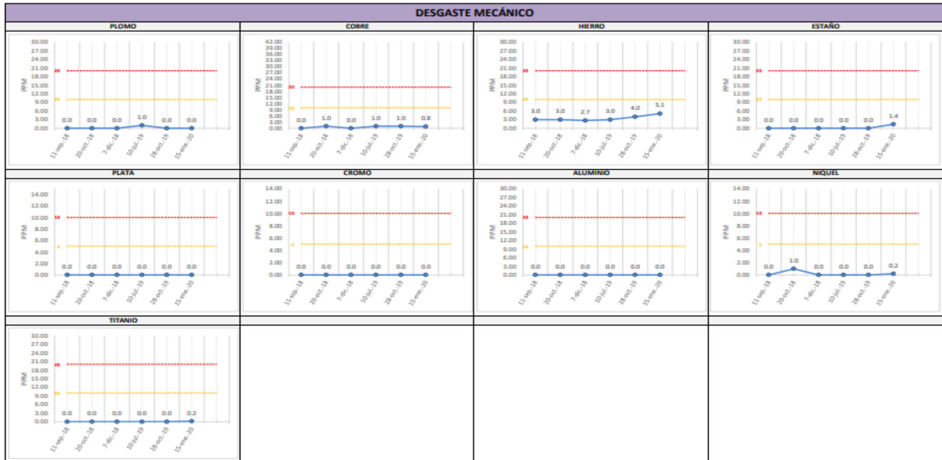
Figura 35. Tendencia de cantidad partículas por desgaste metálico lubricante utilizado en reductor de velocidad TG3.
