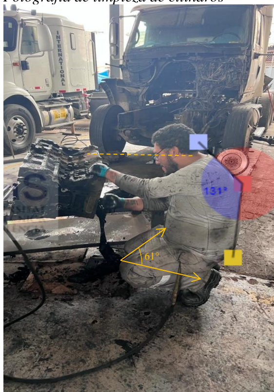
Nota: Fotografía de un técnico realizando limpieza de cilindros de combustión en la empresa International Camiones del Perú S.A. sede Arequipa, 2024.
