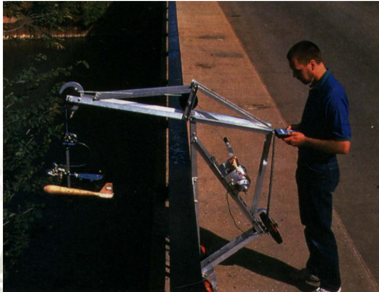
FOTOGRAFIA No. 06. Medición con correntómetro desde un puente.
