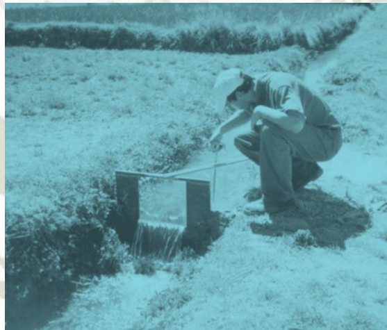
FOTOGRAFÍA No. 10 Medición de la altura de carga.
