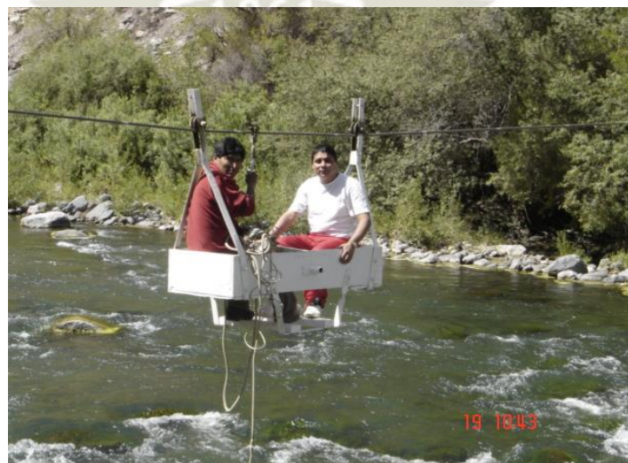
FOTOGRAFÍA No. 05. Medición con Correntómetro suspendido (andarivel)
