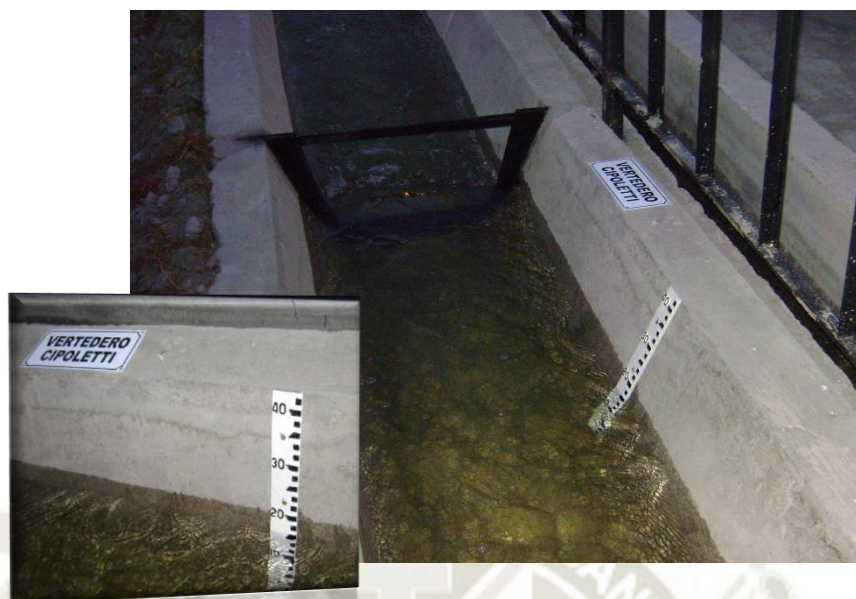
FOTOGRAFÍA No. 37. Vertedero Cipoletti, evaluación de medidor.
