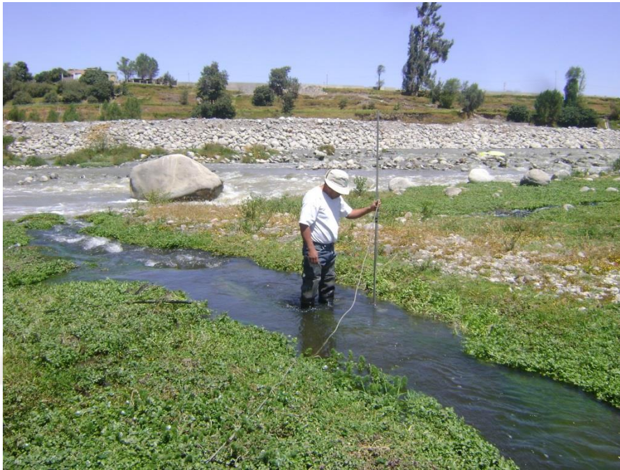
FOTOGRAFÍA No. 04. Medición con correntómetro por vadeo.
