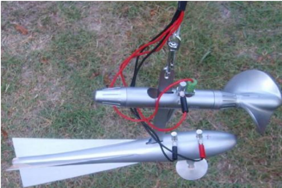
FOTOGRAFÍA No. 03. Correntómetro con hélice y eje horizontal.
