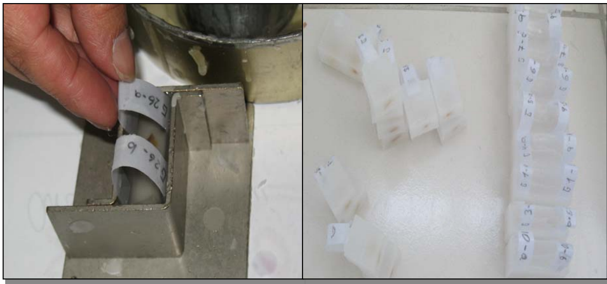
Fig. N° 13-14.- A los tacos se les coloca los códigos preparados para no mezclar las muestras, esperar unos minutos a que seque luego desmoldar y cortar en segmentos individuales cada muestra, Universidad Católica Santa María, Arequipa 2009.
