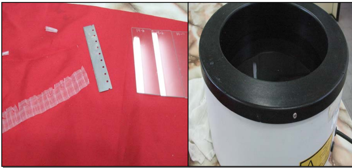
Fig. N° 17-18.- La imagen nos ilustra una tira de cortes histológicos listos para ser Estirados en un equipo llamado Baño María con agua destilada a 45 °C, y permitió extender las muestras, Universidad Católica Santa María, Arequipa 2009.
