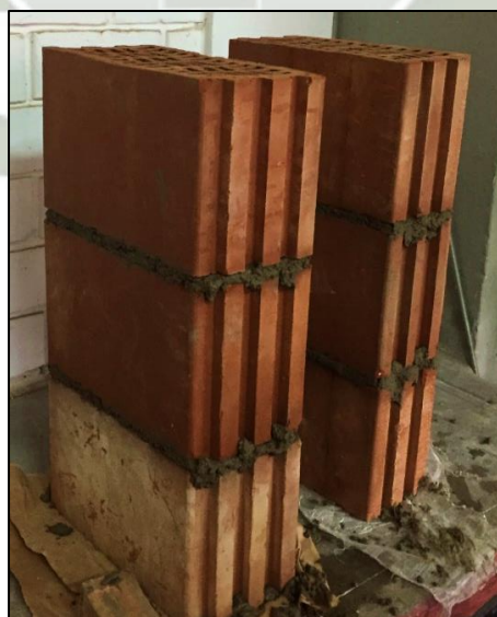
Figura 77: Pilas formadas por bloques de termoarcilla.
