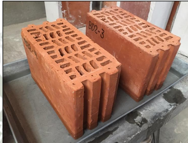
Figura 65: Bloques de termoarcilla sumergidos 2.5 cm en una bandeja durante el ensayo de eflorescencia.
