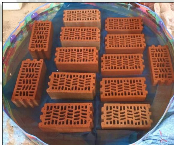
Figura 62: Bloques de termoarcilla en poza de agua para el ensayo de absorción.
