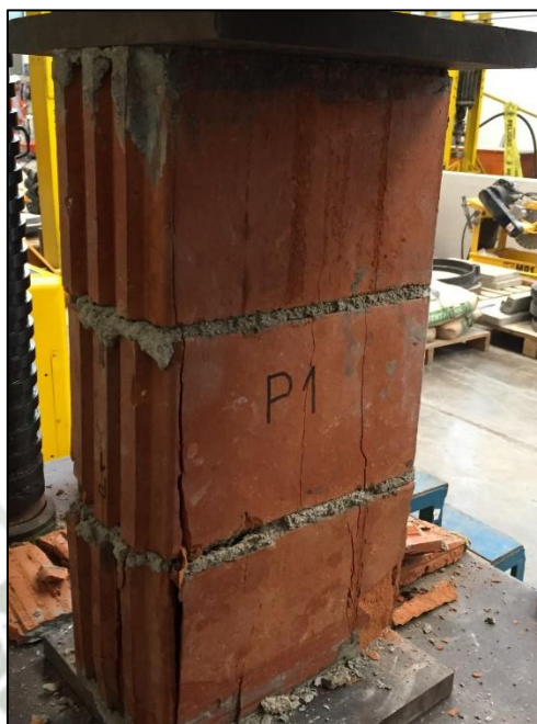
Figura 78: Falla por compresión axial en pila P-1.
