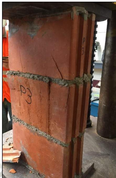
Figura 80: Falla por compresión axial en pila P-3.
