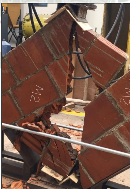
Figura 87: Falla diagonal en murete M – 2.
