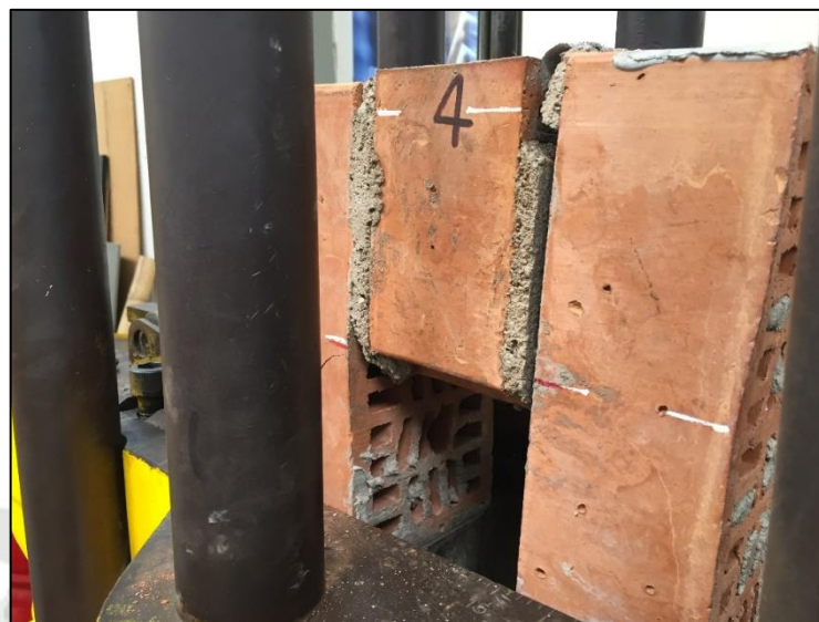
Figura 73: Falla por adherencia del espécimen 3.
