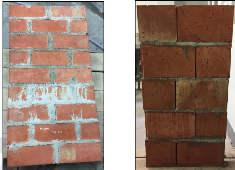
Figura 95: Muro de ladrillo king kong (izquierda) y muro de bloque de termoarcilla (derecha).
