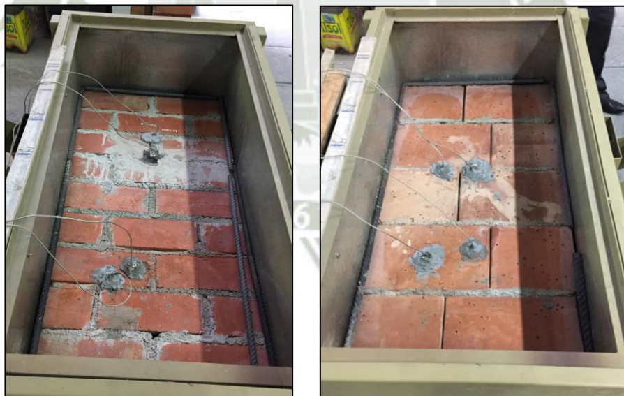
Figura 96: Ensayo térmico en muro de ladrillo king kong (izquierda) y muro de bloque de termoarcilla (derecha).
