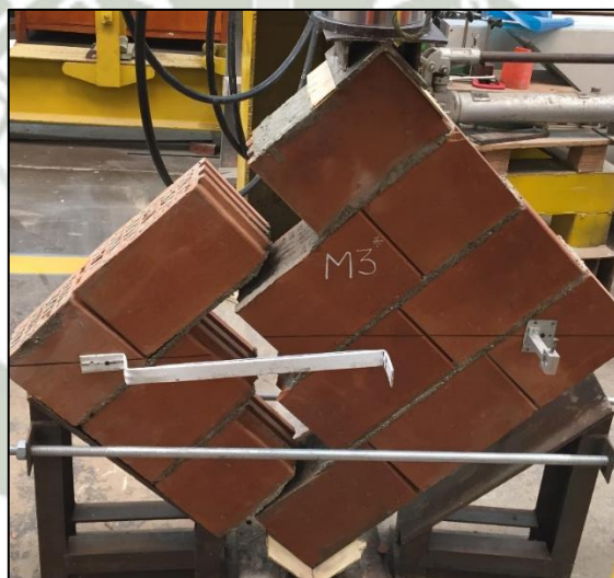
Figura 91: Falla escalonada en murete M - 3*.
