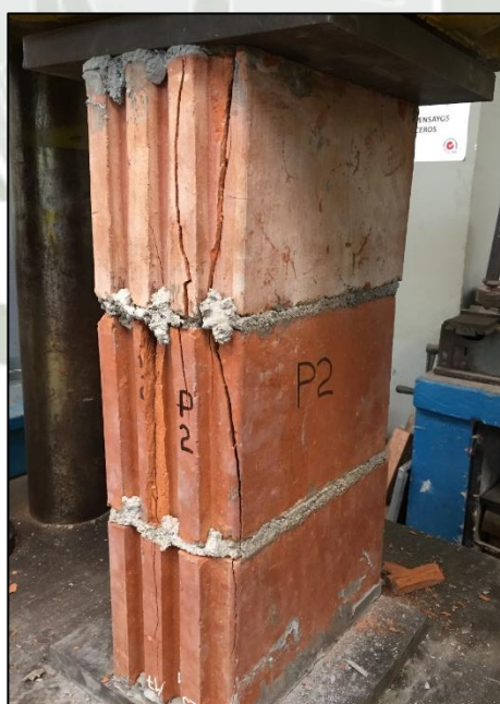
Figura 79: Falla por compresión axial en pila P-2.
