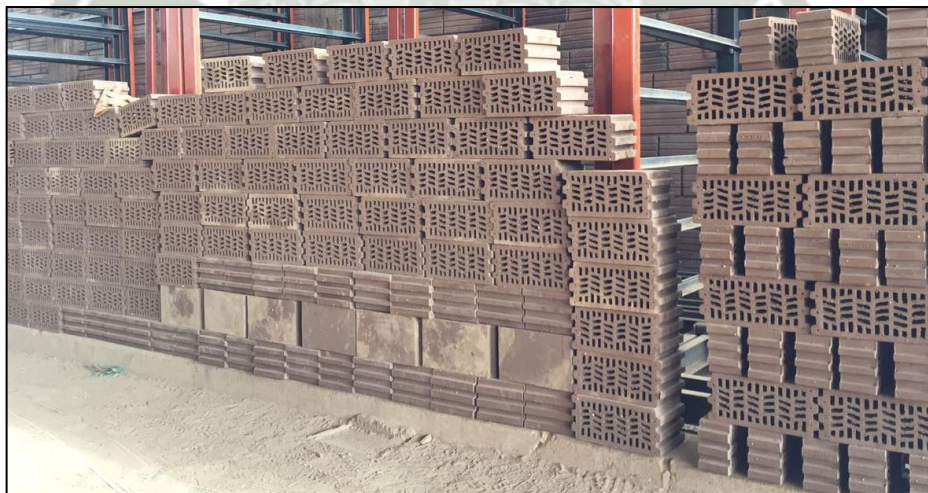
Figura 54: Bloques de termoarcilla durante el secado.
