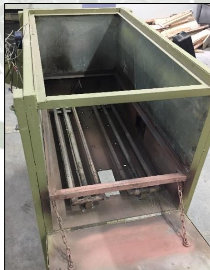
Figura 93: Sistema de quemadores del horno de ensayo.
