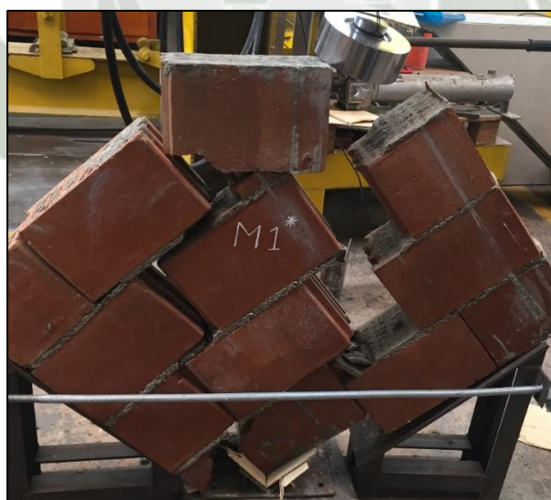
Figura 89: Falla escalonada en murete M – 1*.
