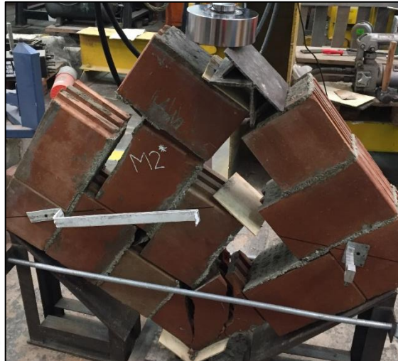
Figura 90: Falla escalonada en murete M - 2*.
