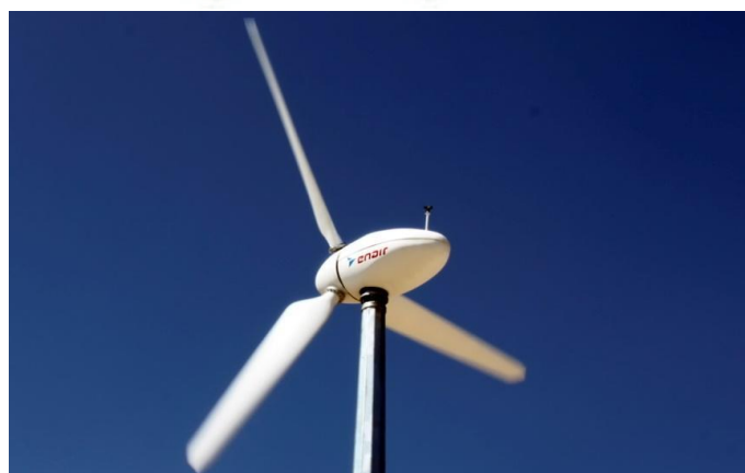
Figura 26 Aerogenerador tripala con rotor a sotavento
