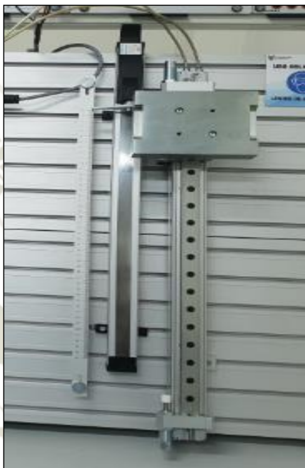
Fig. 96. Montaje del actuador lineal, potenciómetro y regla para un mismo trabajo. Fuente: Propia. Autor: Basurco y Orihuela.
