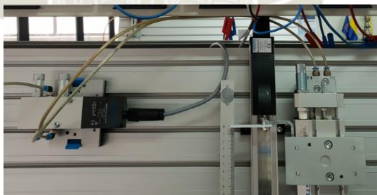
Fig. 103. Conexión de la válvula proporcional como elemento final de control. Fuente: Propia. Autor: Basurco y Orihuela.
