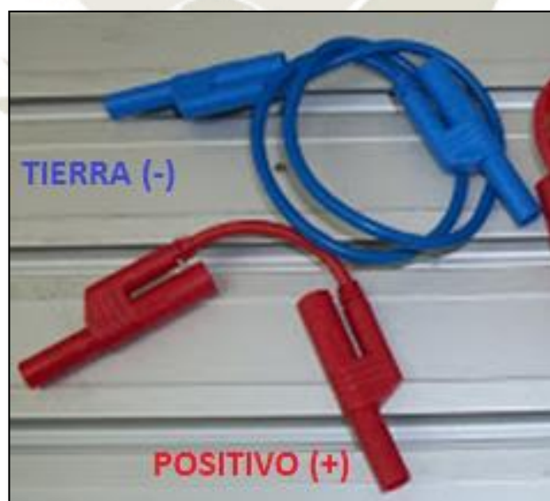
Fig. 89. Cables de seguridad de conexión Fuente: Propia. Autor: Basurco y Orihuela.
