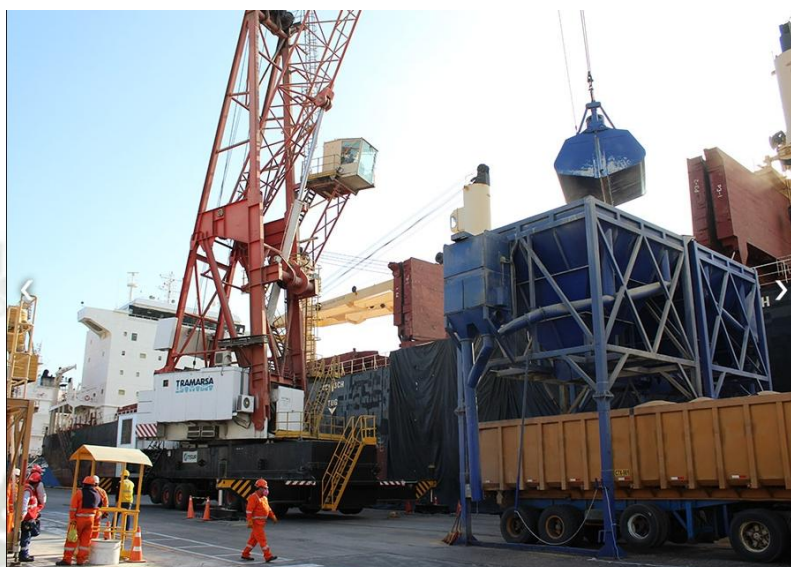
Figura 2-7: Descarga de maíz empleando grúa Clamshell hacia tolvas para despacho en camión.
