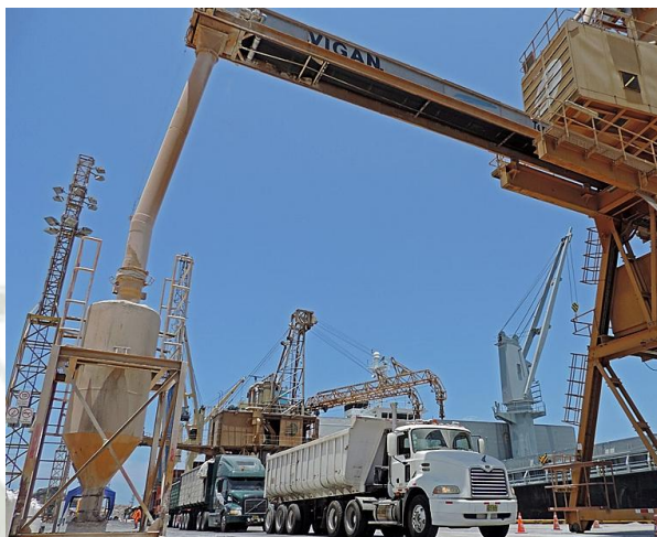
Figura 2-8: Silo con fondo tolva cónico, descarga de granos.
