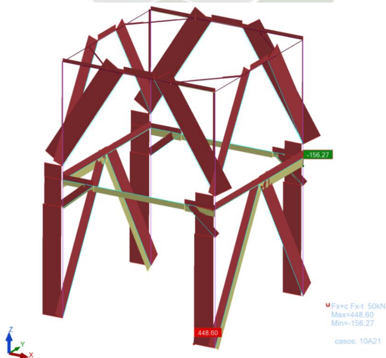
Figura 3-58: Diagrama de Fuerzas axiales de tracción y/o compresión en la estructura base.
