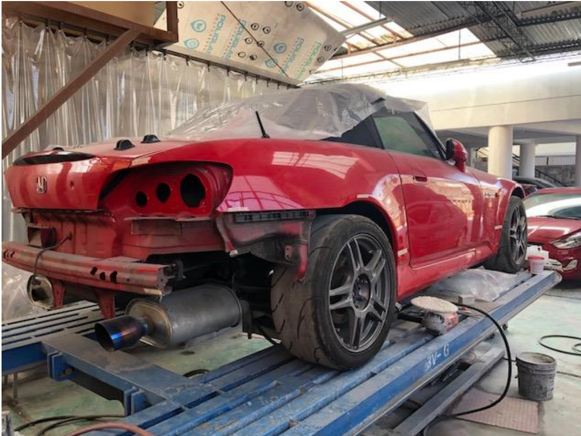
Figura 31 Vista de la zona de traccionado
