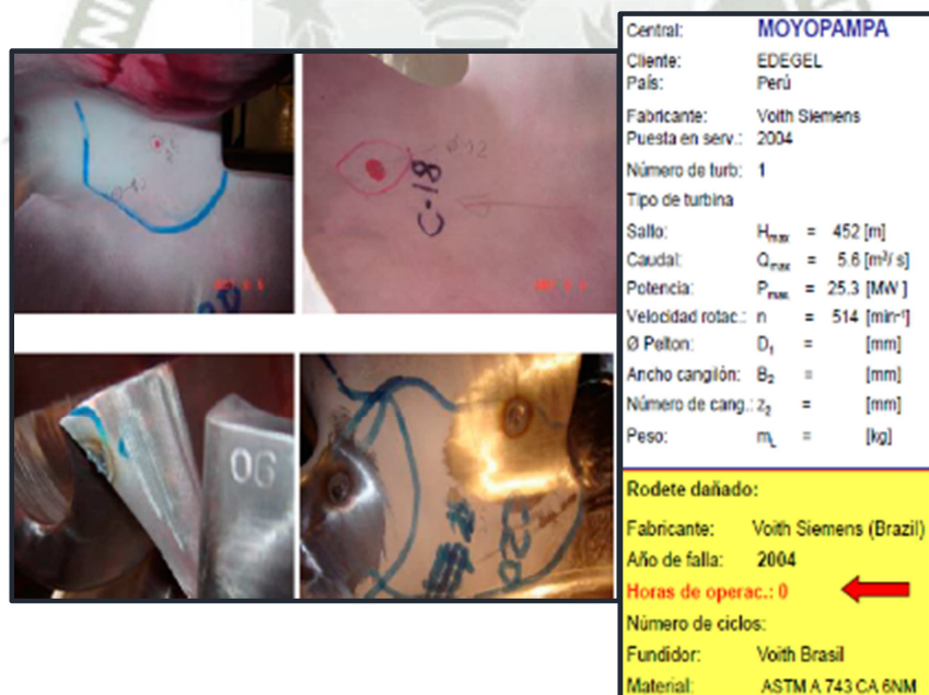
Figura N° 37: Rotura de Cuchara de la Central MAYOPAMPA en 2004 con cero horas de operación.
