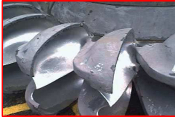
Figura N° 24: Detalles de los álabes de una turbina Peltón
