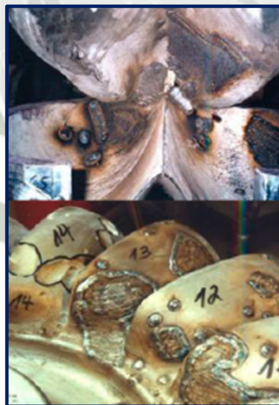
Figura N° 33: Defectos de fabricación de un rodete Pelton por fundición.
