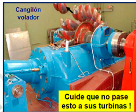
Figura N° 34: Defectos de fabricación de un rodete Pelton por fundición. Fuente: Andritz VAT TECH HYDRO
