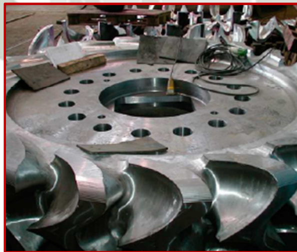
Figura N° 41: Rodete forjado fabricado por Máquina Herramienta CNC.
