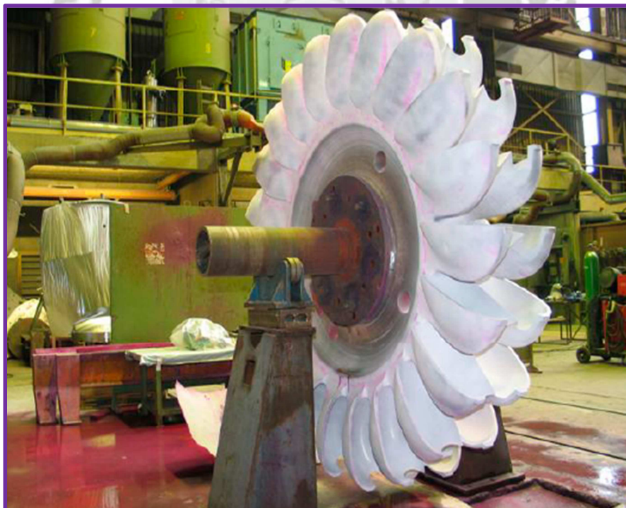
Figura N° 45: Rodetes Completamente Forjados Turbina Pelton
