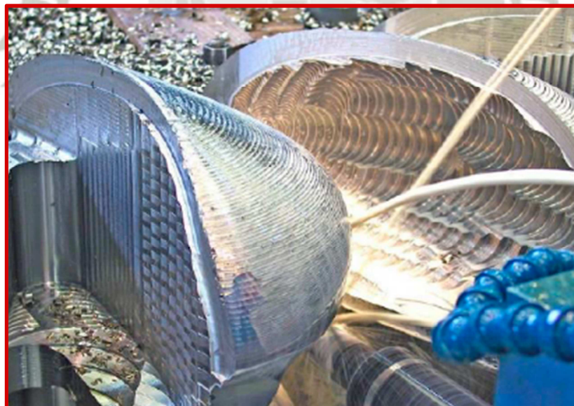
Figura N° 43: Fresado por Control Numérico Cuchara completamente forjado Turbina Pelton.
