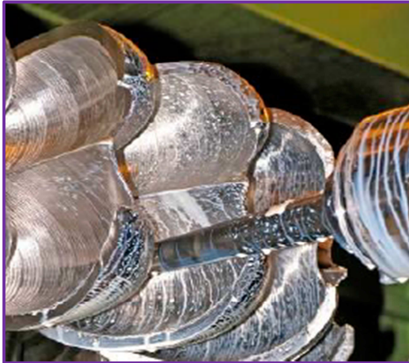
Figura N° 44: Cucharas de la Rueda Pelton en proceso de fresado
