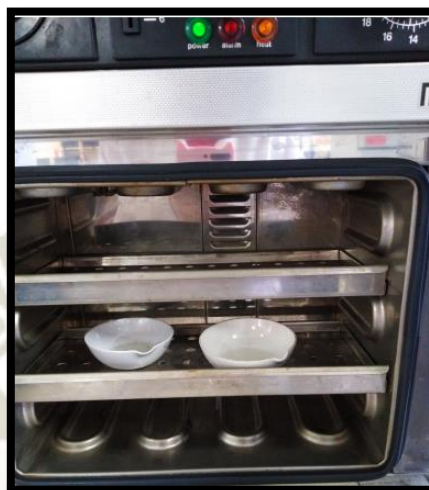
Fig. 30 Determinación de humedad del aceite de Cocos nucífera L.
