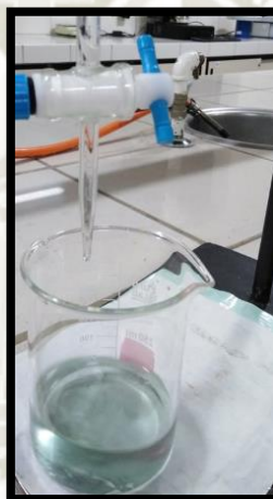
Fig. 18 Punto final en la determinación del índice de yodo
