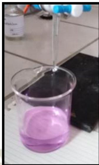
Fig. 14 Punto final en la determinación del índice de acidez
