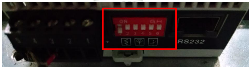
Figura 4-18 Gateway con la configuración de dos hilos
