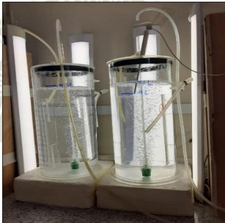
*Figura 9. Fotografía del fotobiorreactor de tubo concéntrico de bucle interno.*
