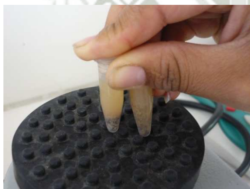
c. Se le agrega 1 ml de H 2 O destilada, y se lo agita en el vortex por 2 min.
