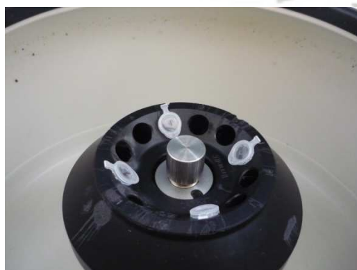
e. Se centrifuga los tubos con la muestra a 4000 rpm x 10 min
