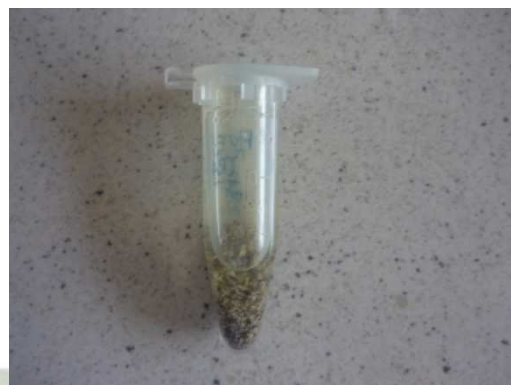
b. Se pesa la muestra y se la coloca en un tubo eppendorf
