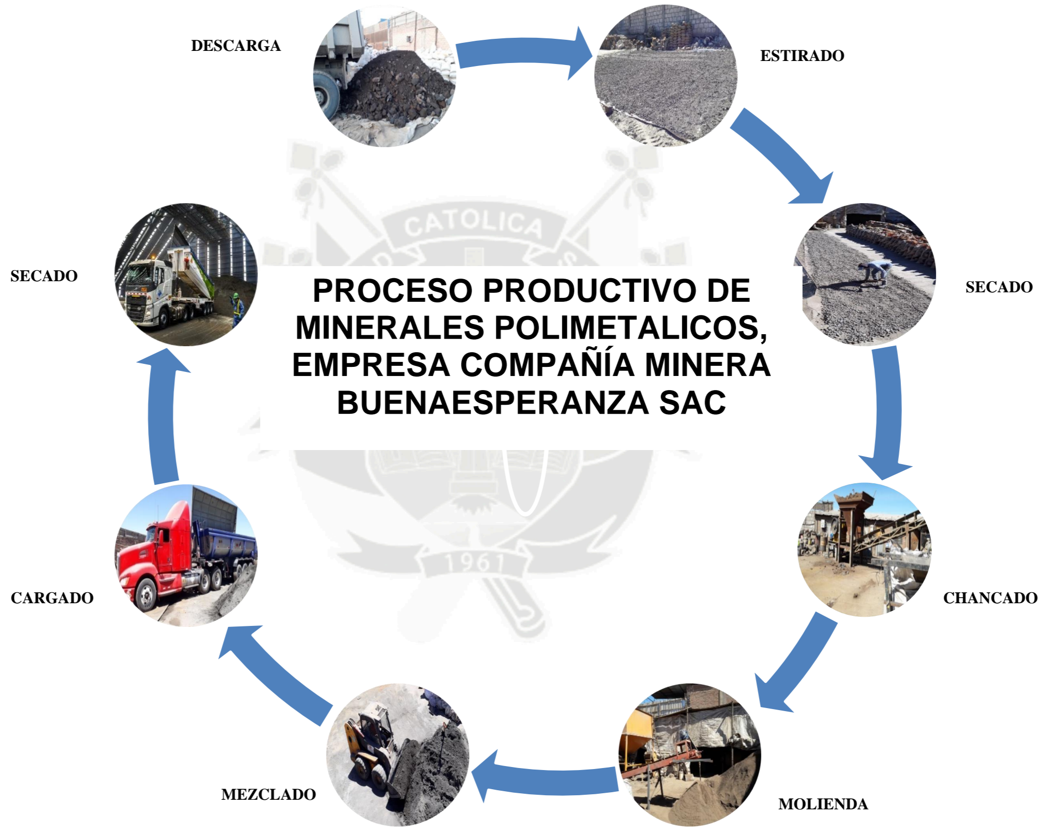
IMAGEN 4: Flow Sheet del proceso productivo
