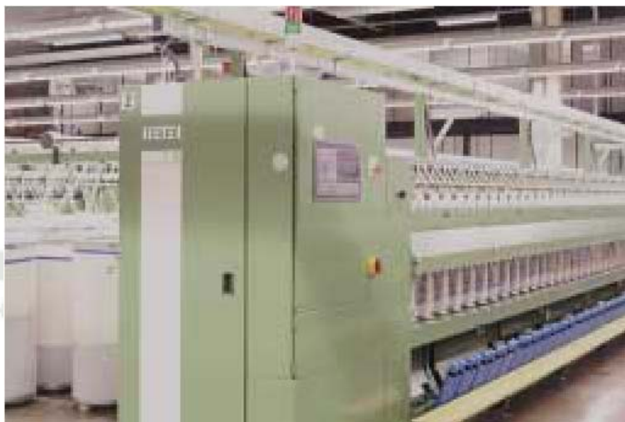
Figura N°03: Máquina Banco de Husos. Planta Hilandería.
