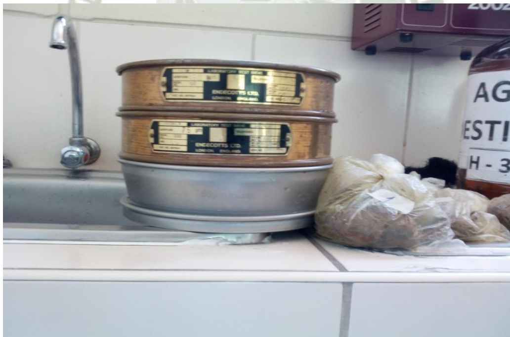
Tamices de 150 \mu m, 75 \mu m, 63 \mu m
