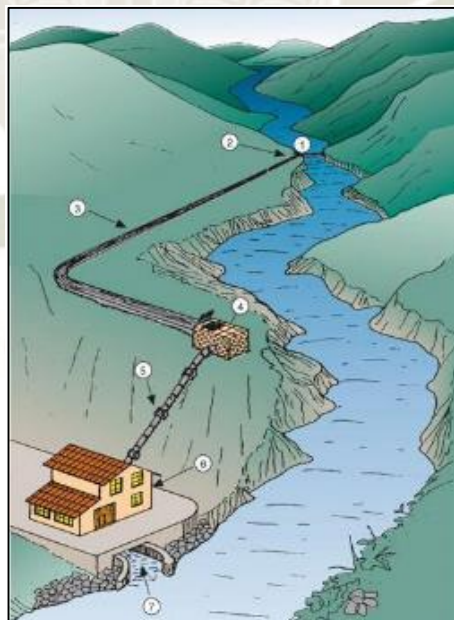
Figura 2.1: Esquema de una central de agua fluvente
