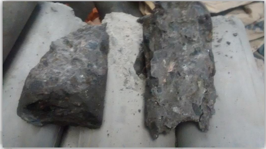
FIGURA 4.4: PROBETAS DE CONCRETO ENSAYADAS
