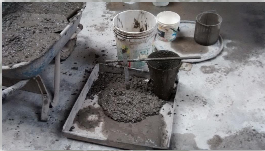
FIGURA 4.1: ENSAYO DE ASENTAMIENTO CON POLIMEROS
