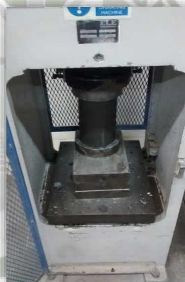
FIGURA 3.12: PROBETA EN PRENSA HIDRAULICA
