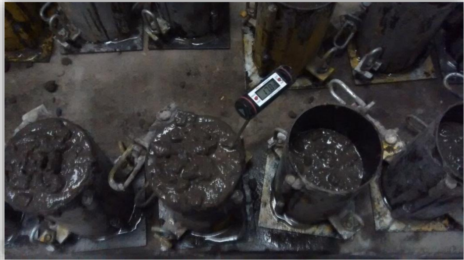
FIGURA 3.11: LECTURA DE TEMPERATURA INTERNA DE CONCRETO
