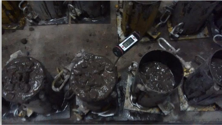
FIGURA 4.2: LECTURA DE TEMPERATURA INTERNA DEL CONCRETO
