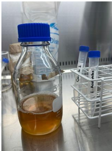
Caldo BHI esterilizado y tubos de ensayo rotulados “Cándida 1” y “L. Acidophilus”
