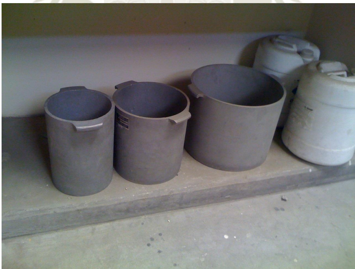
Ilustración 6.- Compactación Agregado Fino.
