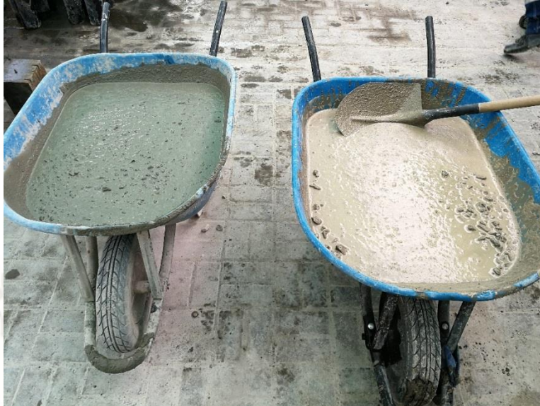
Figura 2.3.- Exudación del Concreto.
