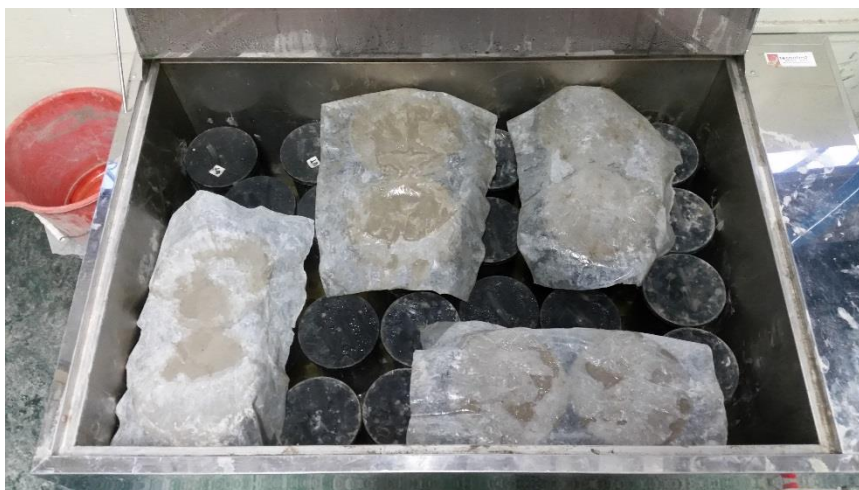
Figura 2.19.- Testigos de Concreto en Cámara de Curado a Vapor.
