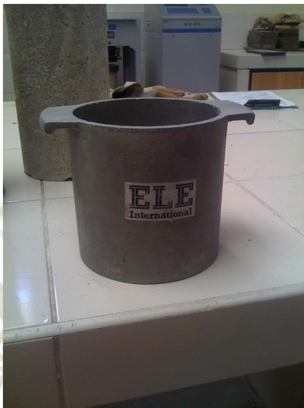
Ilustración 5.- Compactación Agregado Fino.
