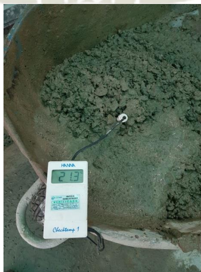
Figura 2.4.- Medición de la Temperatura del Concreto.
