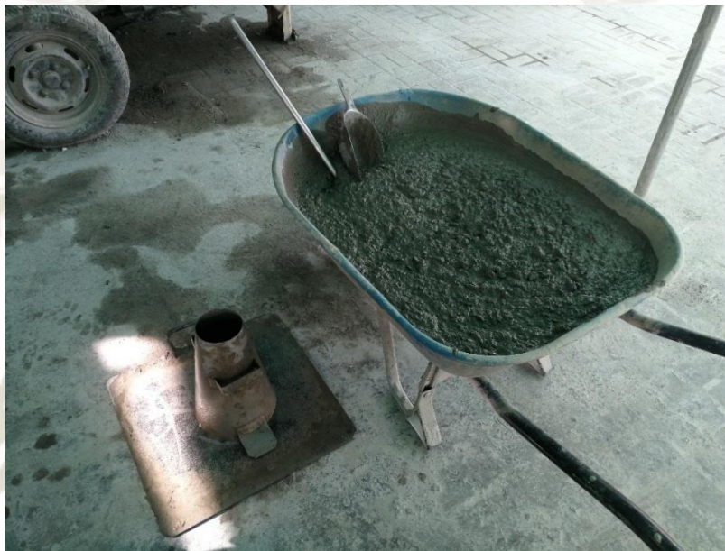
Figura 2.5.- Preparación de la muestra para el Asentamiento.
