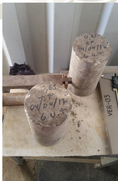
Figura 2.16.- Preparación al ensayo, con el molde y el vernier (Método Brasiler).
