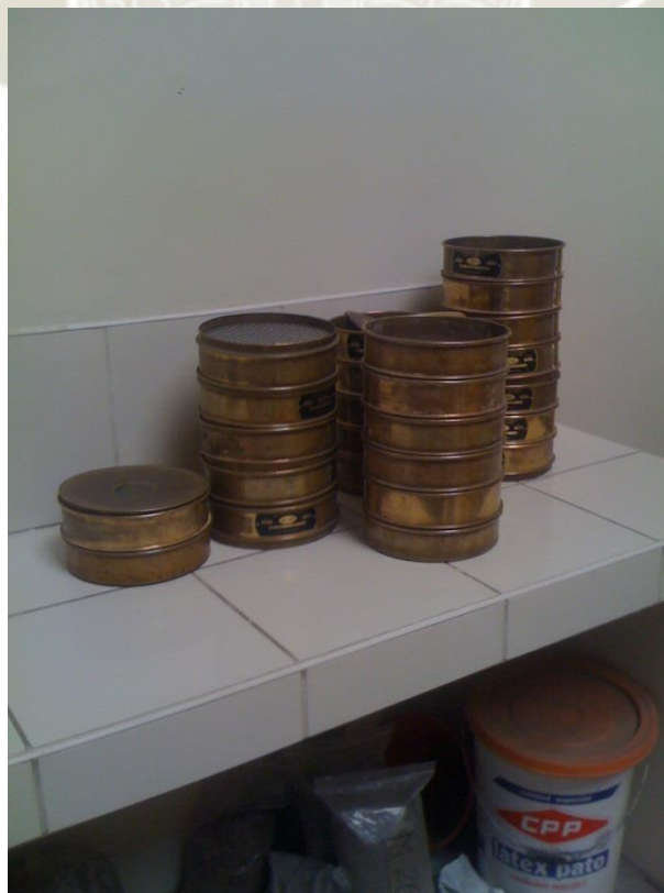
Ilustración 2.- Mallas Agregado Fino.
