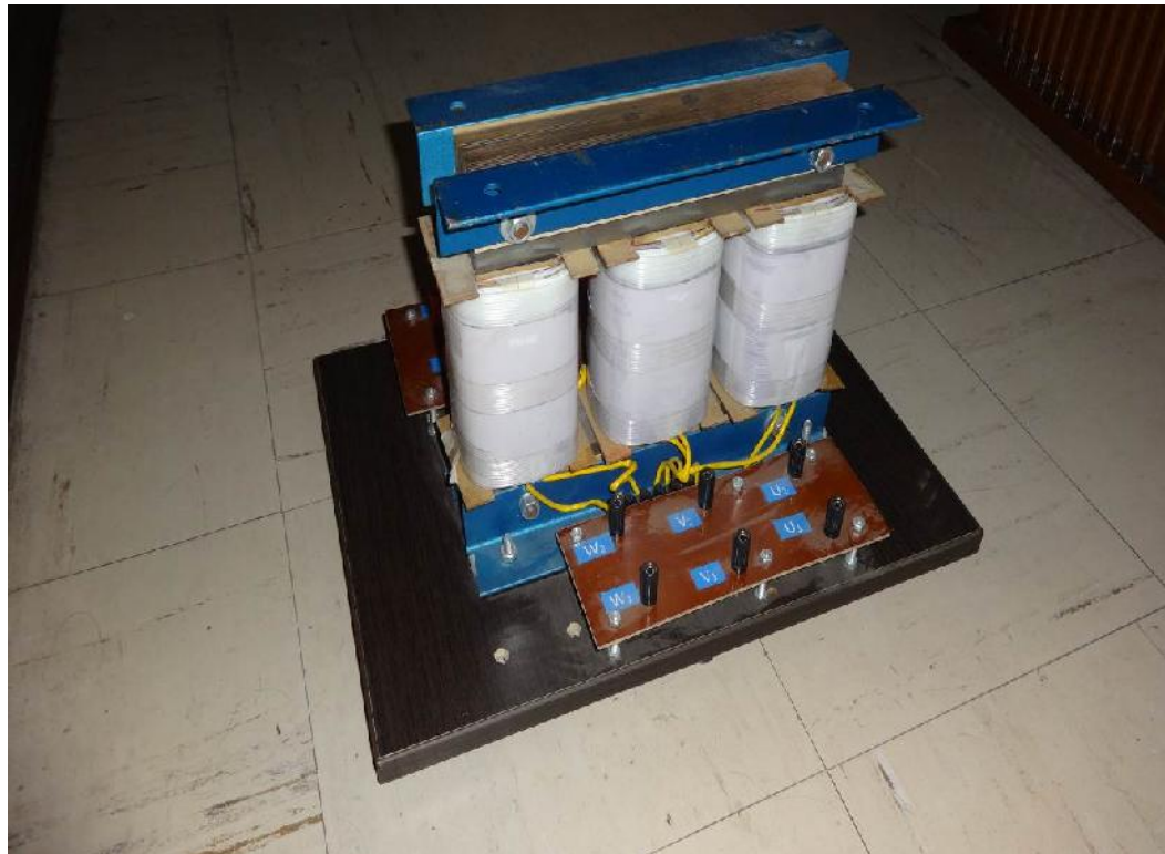
Figura 49: Transformador trifásico componente del modulo
