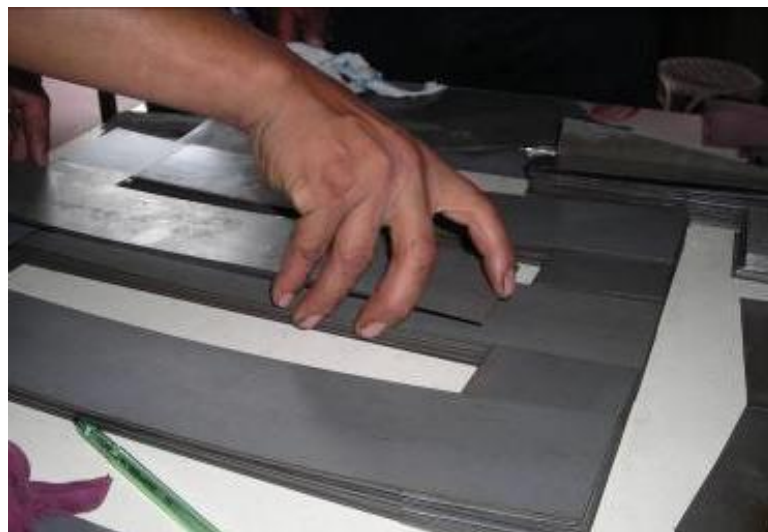
Figura 39: Proceso de armado del núcleo magnético
