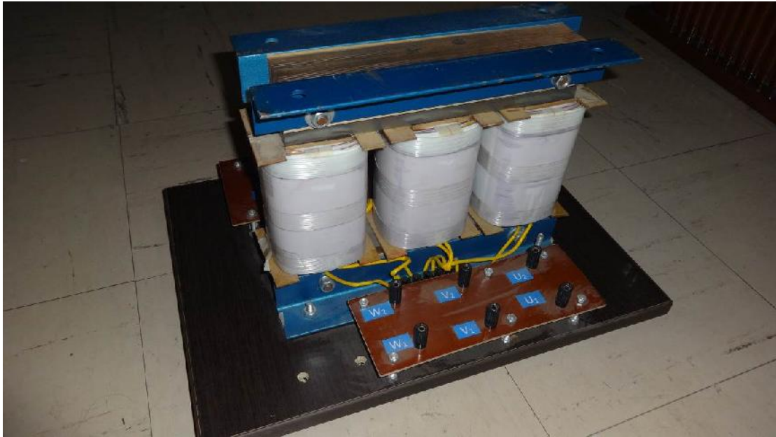
Figura 47: Vista de frente del transformador de potencia trifásico
