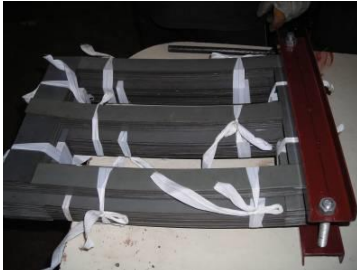
Figura 40:- Prensado del núcleo en forma horizontal con ángulos y varilla roscada
