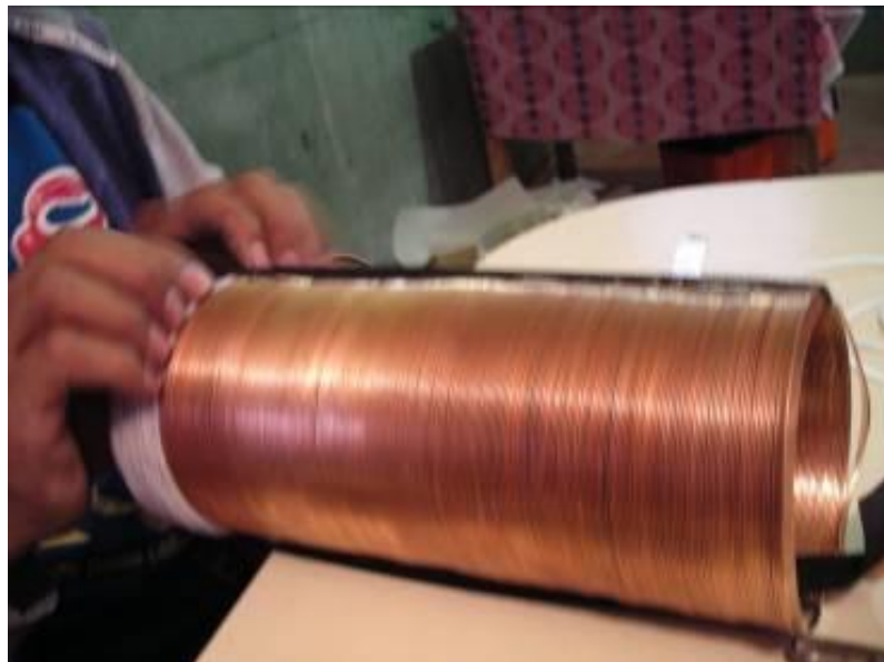
Figura 46: Proceso de aislamiento de bobina
