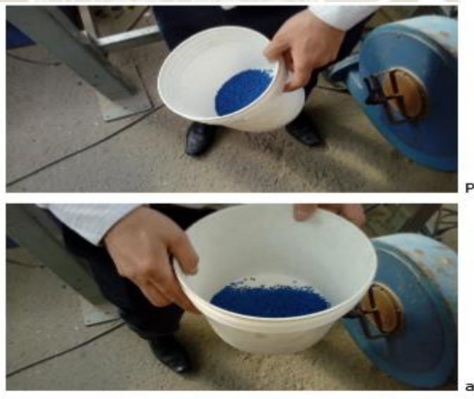
Figura 22 Coloración de polímeros para la fabricación de bolsas.
